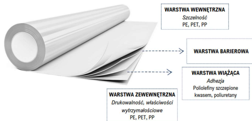
Rysunek 2. Budowa folii wielowarstwowej
