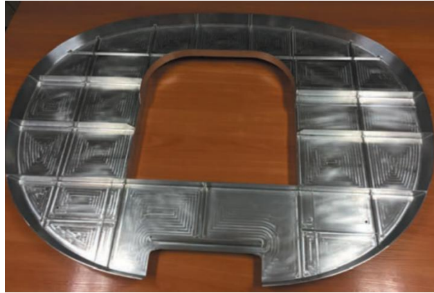
Rys. 2.5. Wrega samolotu wykonana w procesie frezowania (EN AW-7075) [33]
