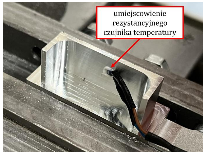
Rys. 3.14. Umieszczenie rezystancyjnego czujnika temperatury na próbce
