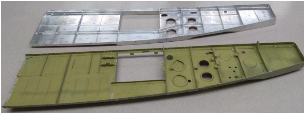
Rys. 2.6. Belka samolotu wykonana w procesie frezowania HSM ze stopu EN AW-7075 oraz w sposób tradycyjny poprzez nitowanie wielu elementów [35]
