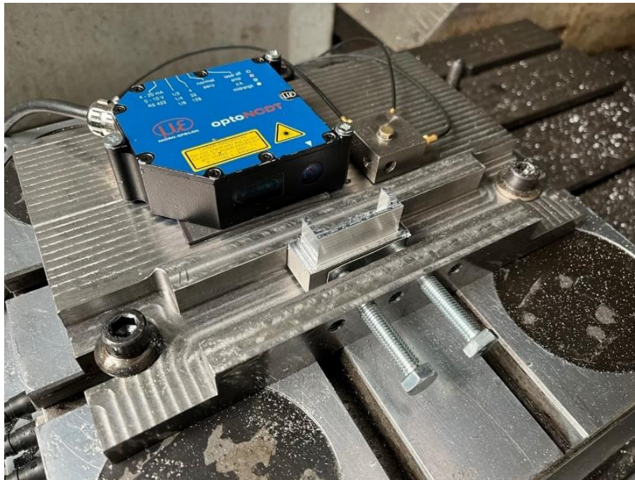
Rys. 3.9. Stanowisko pomiarowe elementów cienkościennych podczas frezowania w zakresie obróbki konwencjonalnej
