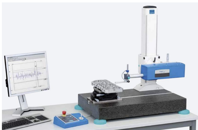
Rys. 3.15. Stanowisko do pomiaru chropowatości oraz topografii. Profilografometr T8000 firmy Hommelwerke
