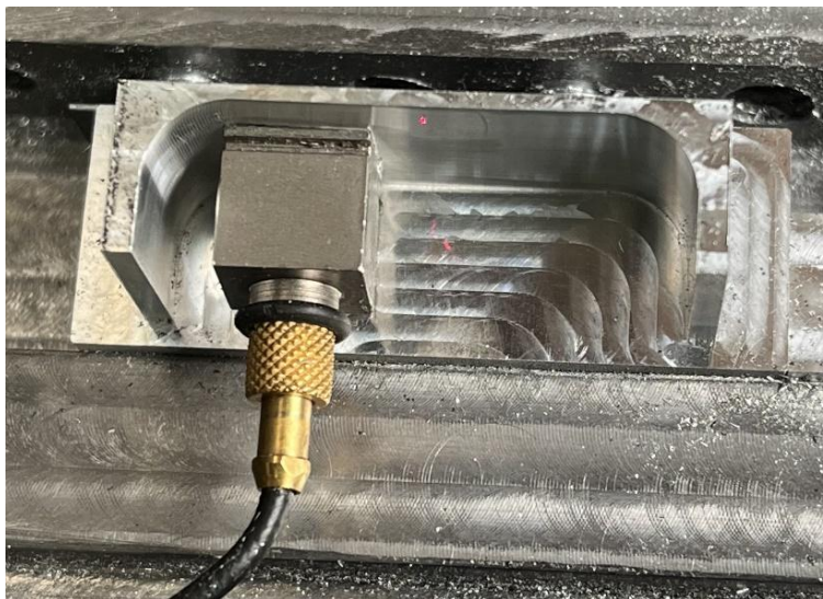
Rys. 3.21. Umieszczenie czujnika drgań na próbce badawczej w zakresie obróbki HSM
