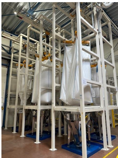
Rys. 6.19 Centralny system podawania – surowiec pierwotny i płatek PET
