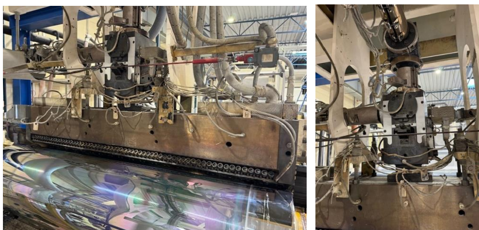
Rys. 6.11 Blok łączący warstwy i głowica wylewająca
