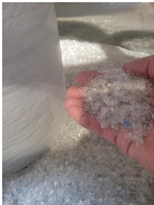
Rys. 6.19 Centralny system podawania – surowiec pierwotny i płatek PET
