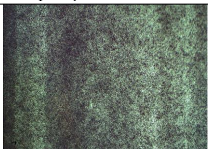
Struktura materiału PP+ 10%Bio C rozciąganego z prędkością 1m/min, powiększenie x10
