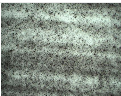
Struktura materiału PP+ 10%Bio C rozciąganego z prędkością 4m/min, powiększenie x10
