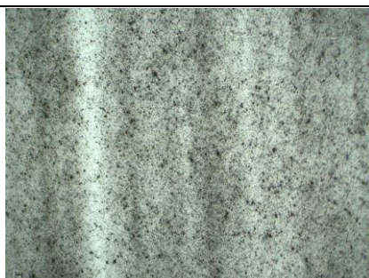
Struktura materiału PP+5%Bio C rozciąganego z prędkością 4m/min, powiększenie x10
