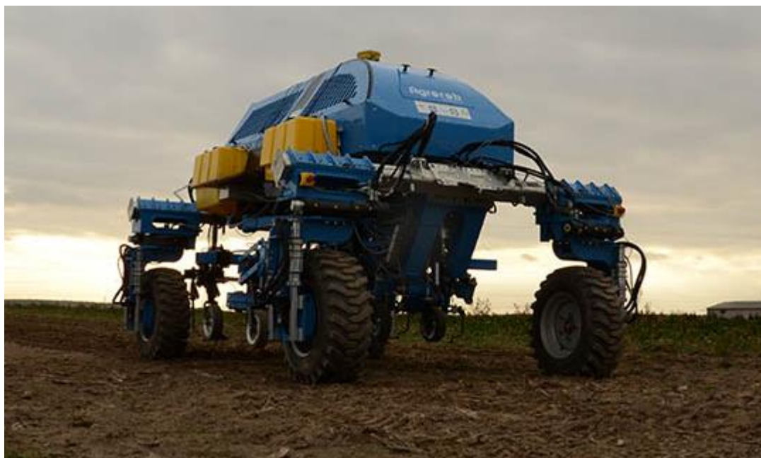
Rys. 2.10. Autonomiczny robot polowy do siewu i pielęgnacji upraw szerokorzędowych [1]
