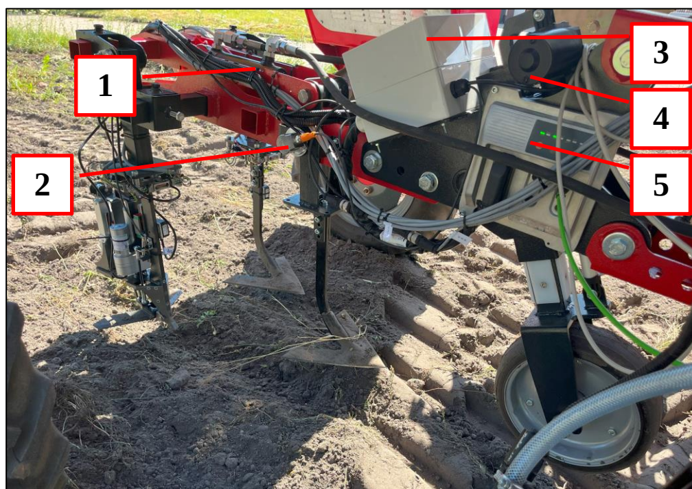
Rys. 7.5. Stanowisko badawcze – mechatroniczna sekcja pieląca, widok na elementy wykonawcze i pomiarowe
