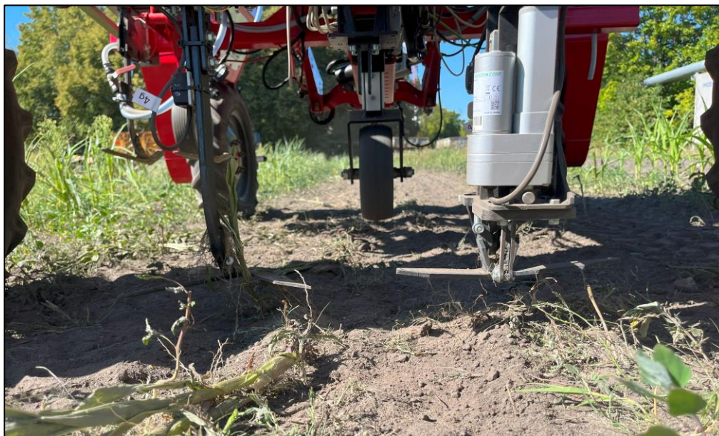
Rys. 7.6. Stanowisko badawcze – mechatroniczna sekcja pieląca z narzędziem o zmiennej geometrii zamontowana na pojeździe autonomicznym w konfiguracji z dwoma narzędziami
