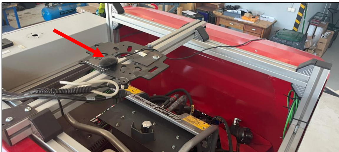
Rys. 7.7. Antena GPS zamontowana w środku geometrycznym autonomicznego robota
