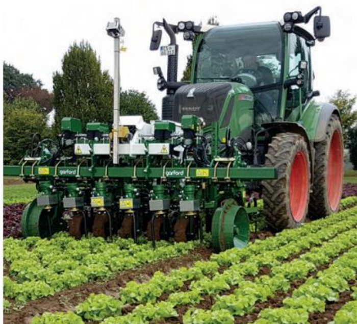
Rys. 2.27. Robocrop inrow firmy Garford - pielnik do pielęgnacji międzyrzędzi oraz przestrzeni między roślinami w rzędach [10]
