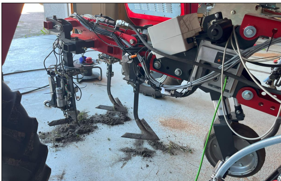
Rys. 9.8. Mechatroniczna sekcja pieląca z narzędziem o zmiennej geometrii elementów skrawających glebę
