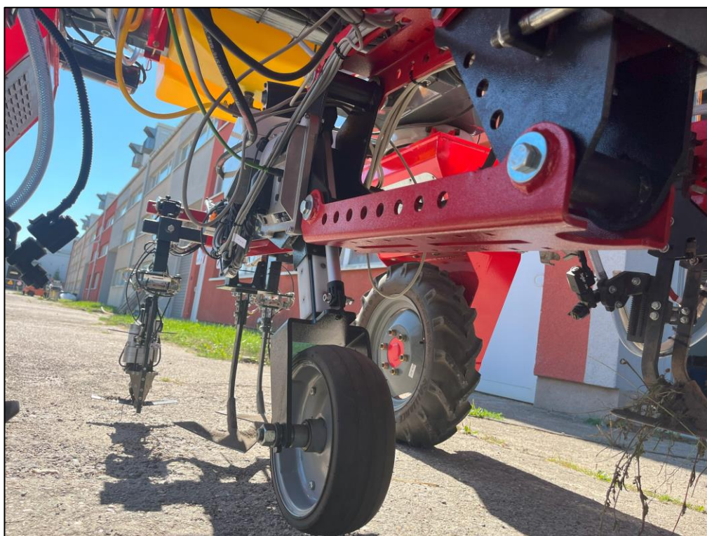
Rys. 7.3. Stanowisko badawcze – mechatroniczna sekcja pieląca z narzędziem o zmiennej geometrii zamontowana na pojeździe autonomicznym
