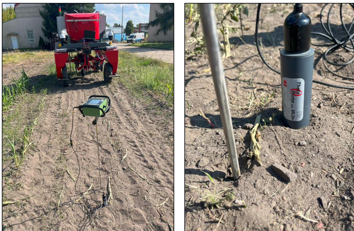
Rys. 7.9. Penetrologger firmy Eijkelkamp do pomiaru oporów penetracji gleby oraz wilgotności w czasie badań na polu badawczym
