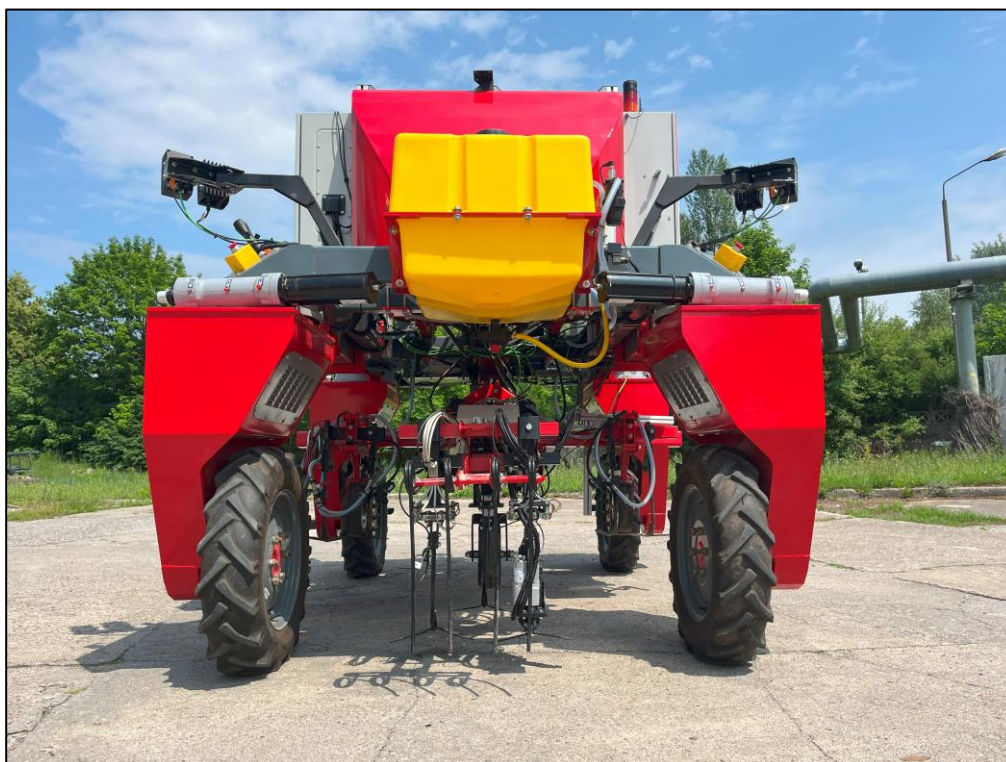
Rys. 7.2. Autonomiczny robot polowy firmy Unia z napędami elektrycznymi z zamontowanym stanowiskiem badawczym
