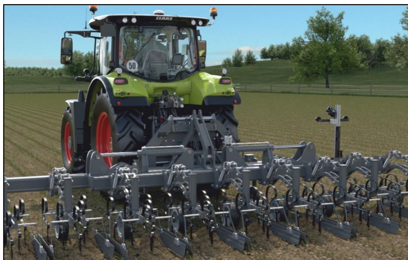
Rys. 2.24. Pielnik z wizyjnym systemem Culti Cam naprowadzania narzędzi na międzyrzędzia roślin [10]
