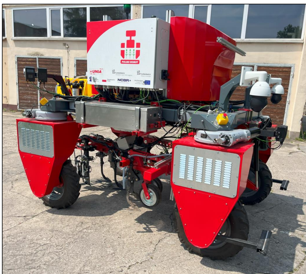
Rys. 7.1. Autonomiczny robot polowy firmy Unia z napędami elektrycznymi z zamontowanym stanowiskiem badawczym
