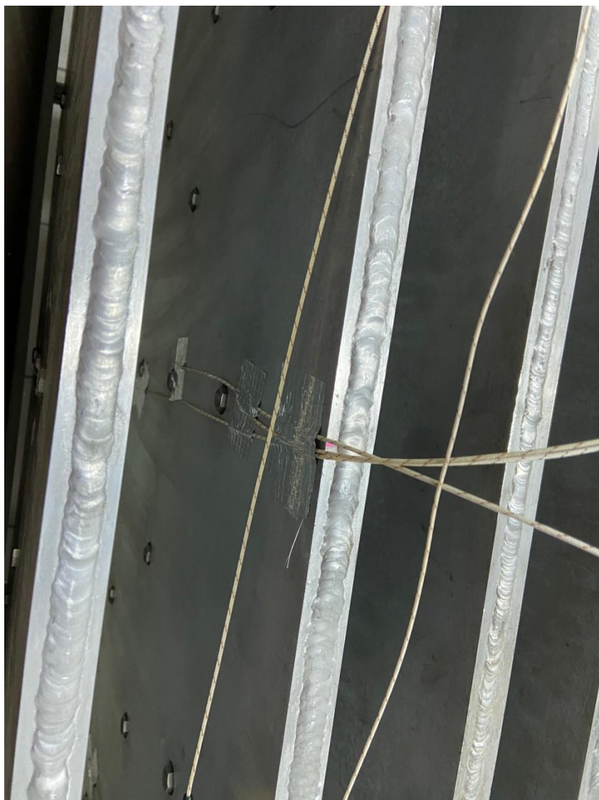
Rys. 3.7. Umieszczenie termopar na powierzchni płyty mroźniczej- sposób oklejania
