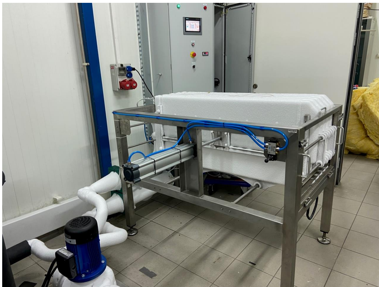
Rys. 3.2. Widok stanowiska badawczego- zamrażarka płytowa podczas cyklu mrożenia
