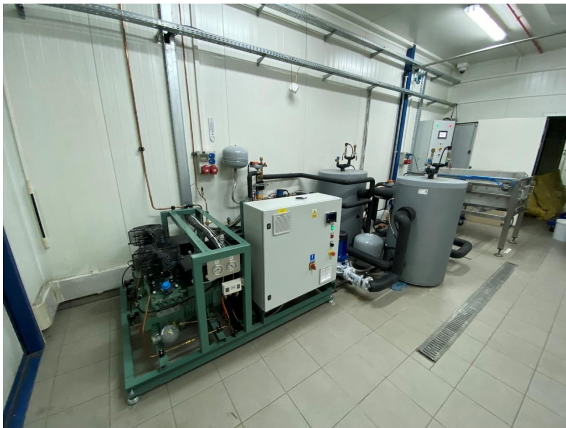
Rys. 3.3. Zdjęcie stanowiska badawczego- agregat chłodniczy
