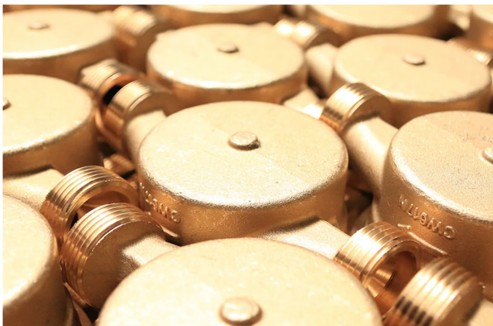
Rys. 4.1 Widok ogólny na obrabiane korpusy wodomierza mieszkaniowego ( https://www.fa-swarzedz.com.pl/korpusy-wodomierzy-i-cieplomierzy/ , 2024)
