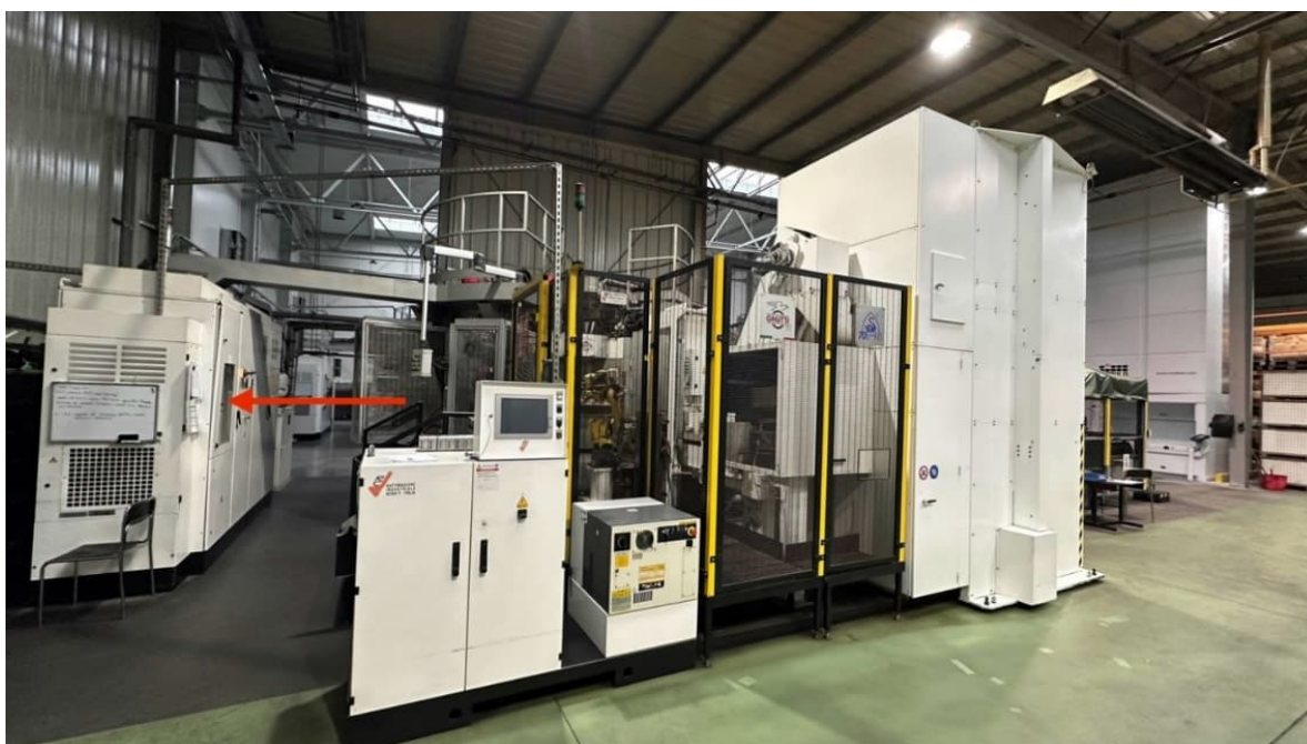
Rys. 5.3. Widok obrabiarki transferowej GNUTTI 233 ze wskazaniem szafy elektrycznej
