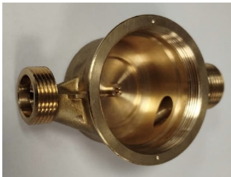
Rys. 4.5 Korpus wodomierza po operacji obróbki skrawaniem
