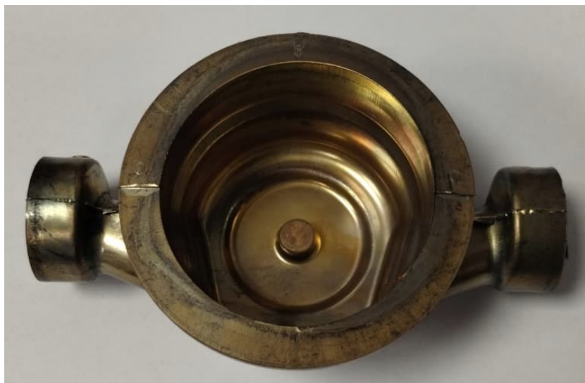
Rys. 4.3 Korpus wodomierza po operacji kucia matrycowego
