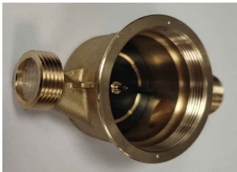
Rys. 4.6 Korpus wodomierza po operacji montażu płyty spiętrzającej, sitka i ośki wirnika
