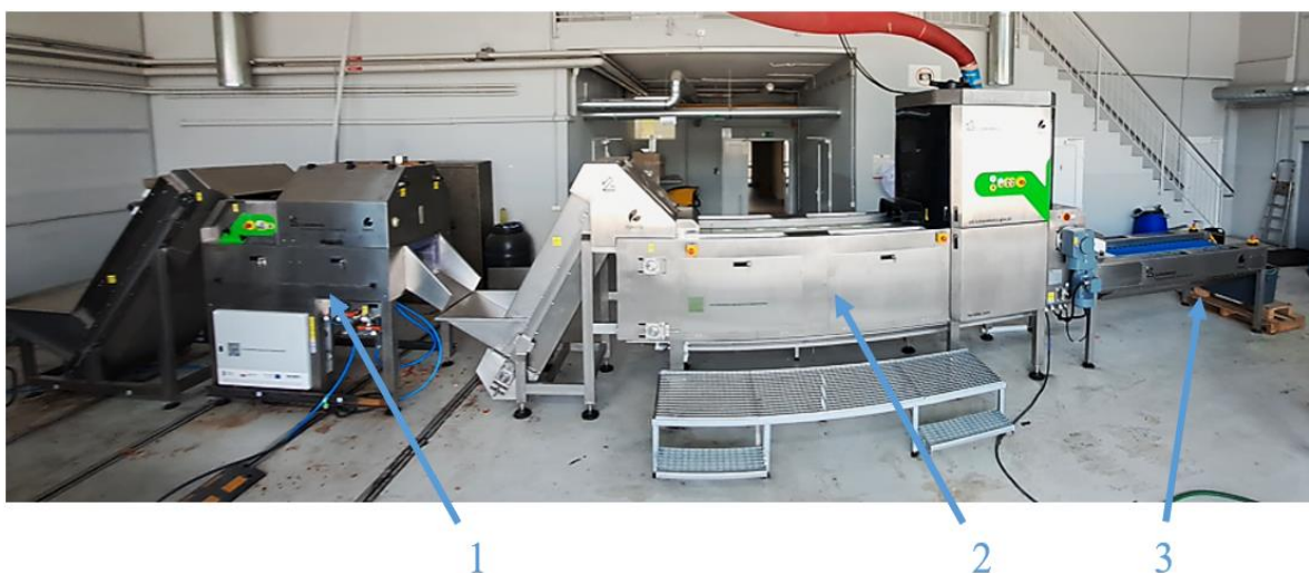
Rys. 6.3. Przemysłowa linia do obróbki cebuli: 1) moduł usuwania suchej łuski, 2) moduł wycinania szczypioru i korzenia, 3) moduł doczyszczania ręcznego
