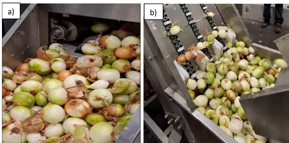
Rys. 6.10. Efektywność oczyszczania cebuli: a) p = 6,5 bar, b) p = 7,5 bar
