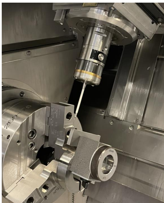
Rys. 5.64 Widok podczas pomiaru płytki wzorcowej L=100 mm.
