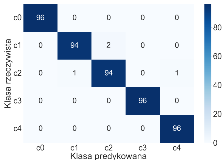
Rys. 7.11: Macierz błędów modelu dziedziny częstotliwości dla 5 klas z pojedynczymi uszkodzeniami w postaci wygiętej końcówki śmigła
