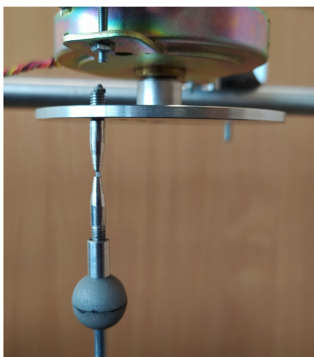
Rysunek 5.9. Fotografia przedstawiająca sposób zawieszenia pręta na tarczy
