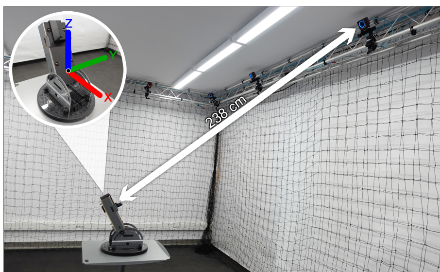
Rysunek 3.13: Narzędzie pomiarowe umieszczone w laboratorium wyposażonym w kamery OptiTrack Prime x 13W. Odległość pomiędzy kamerą a testowanym materiałem wynosiła około 238 cm. Na zdjęciu zaznaczono układ współrzędnych narzędzia pomiarowego.
