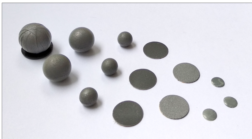
Rysunek 2.8: Zestawienie różnych markerów pasywnych, używanych w ramach badań. Różnice odnoszą się do typu użytego materiału, średnicy oraz typu znacznika (sferyczny, płaski).
