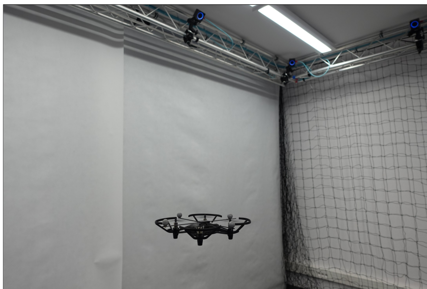
Rysunek 4.2: Lekka jednostka latająca wykorzystana w testach walidacyjnych – DJI Tello EDU. Zdjęcie wykonano podczas przeprowadzania eksperymentu.
