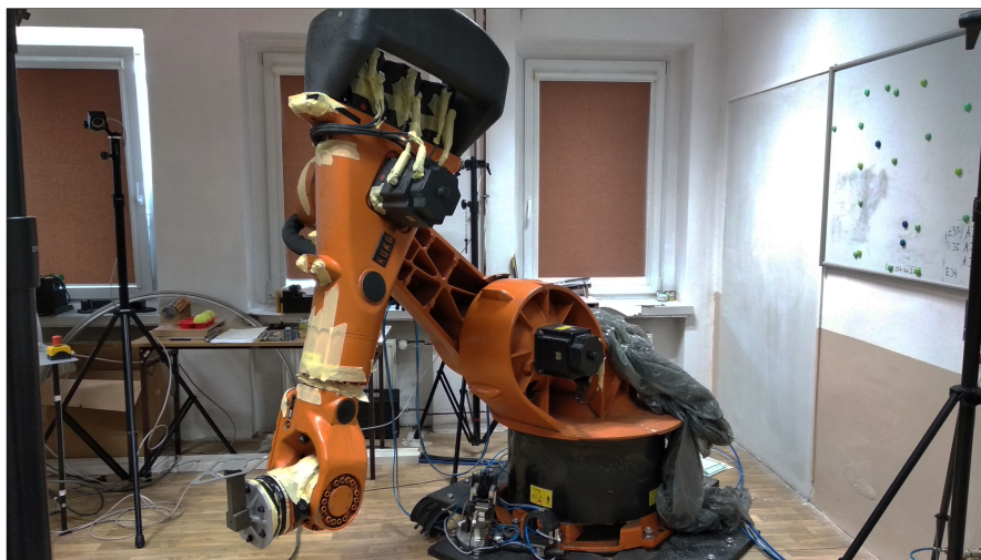
Rysunek 4.5: Manipulator Kuka KR200/2. Jednostka została wykorzystana z uwagi na wysoką powtarzalność ruchu, duży obszar przestrzeni roboczej oraz odtwarzalność zaprogramowanej trajektorii. Żółta taśma została użyta w celu zamaskowania powierzchni, która potencjalnie mogłaby zwiększać prawdopodobieństwo pojawienia się fałszywych markerów.
