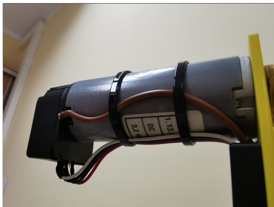
Rysunek 4.1: Zestaw laboratoryjny – badany silnik prądu stałego.
