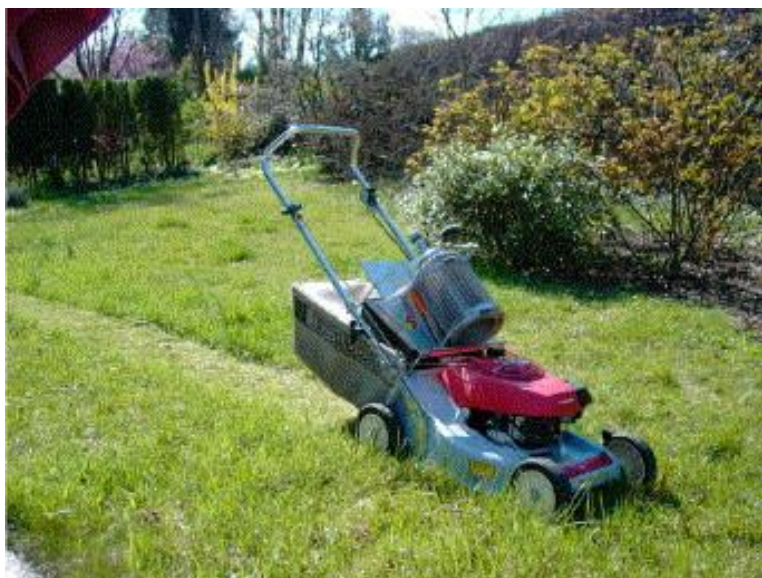
Rys. 3.4. Kosiarka z silnikiem ZI zasilanym wodorem [99]
