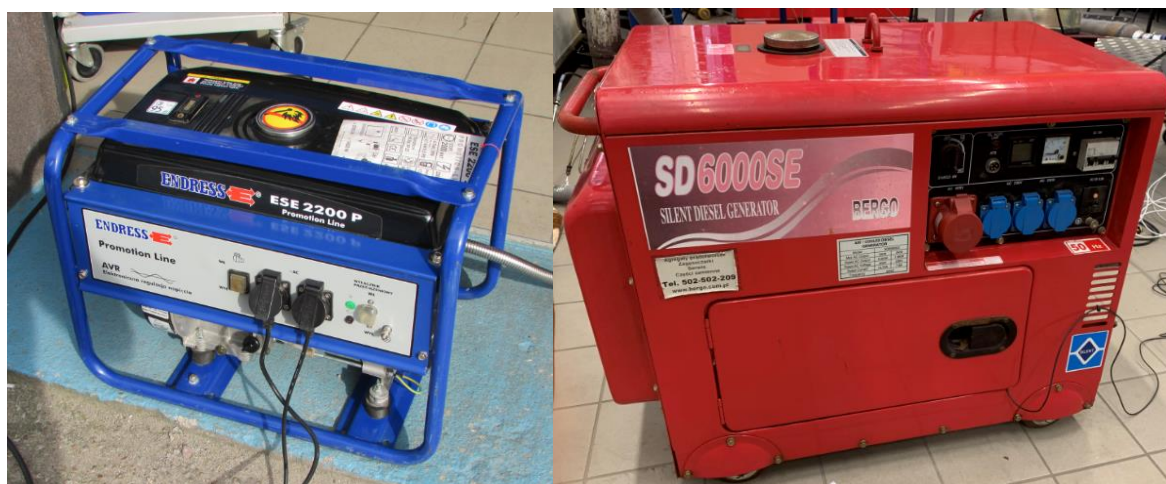
Rys. 2.10. Generatory prądotwórcze zasilane silnikami ZI i ZS
