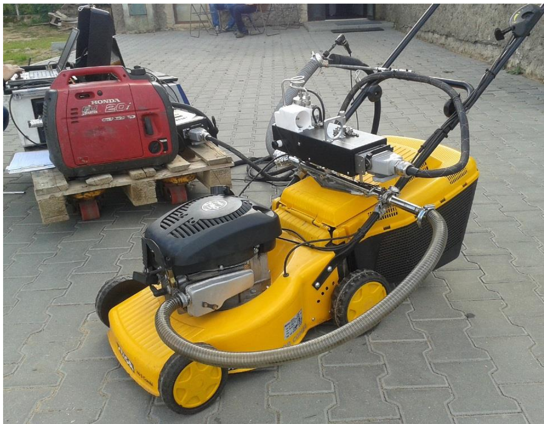
Rys. 6.1. Kosiarka kołowa spalinowa ZI z zamontowaną aparaturą pomiarową
