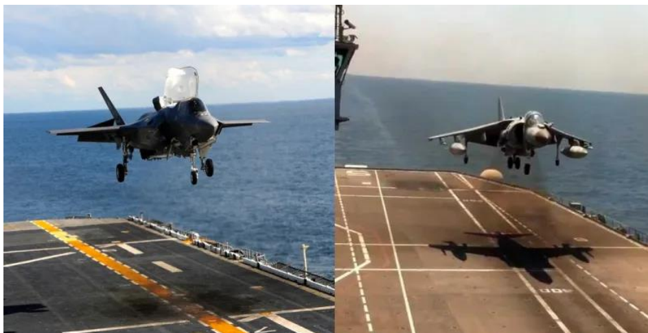
Rys. 2. F-35 Lightning II i Hawker Siddeley Harrier – pionowe lądowanie [2]
