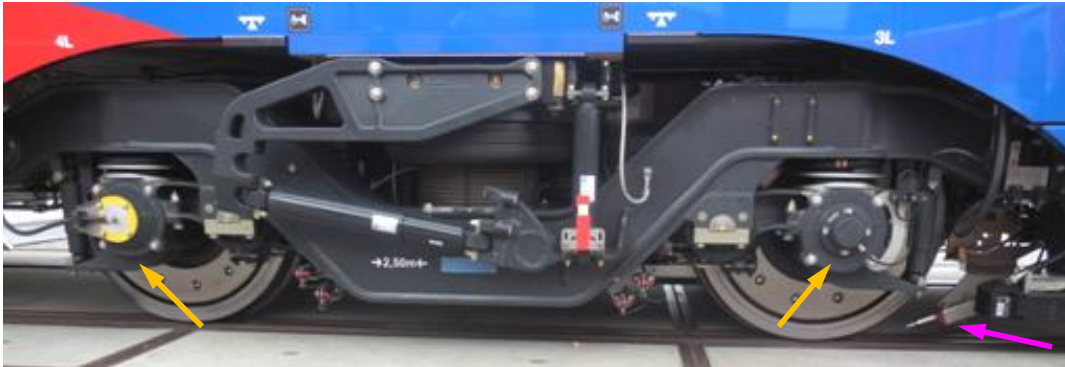
Rys. 7.6. Widok wózka z urządzeniami przeciwpoślizgu oraz jednym zestawem do piaskowania pierwszego zestawu kołowego [fot. A.M. Rilo Cañás],
