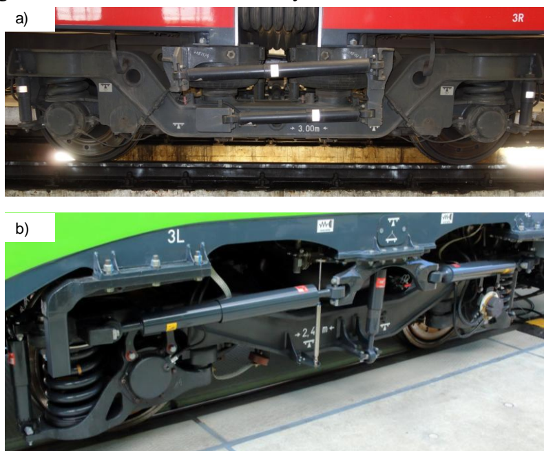
Rys. 7.7. Widok wózka Jakobsa z: a) tradycyjnym mocowaniem tłumika wężykowania [fot. A.M. Rilo Cañas], b) nowoczesnym podwójnym mocowaniem centralnie dwóch tłumików wężykowania [113]
