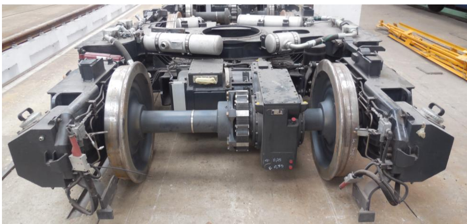
Rys. 3.3. Widok wózka napędowego 34MN z widoczną przekładnią i silnikiem trakcyjnym [fot. A.M. Rilo Cañás]
