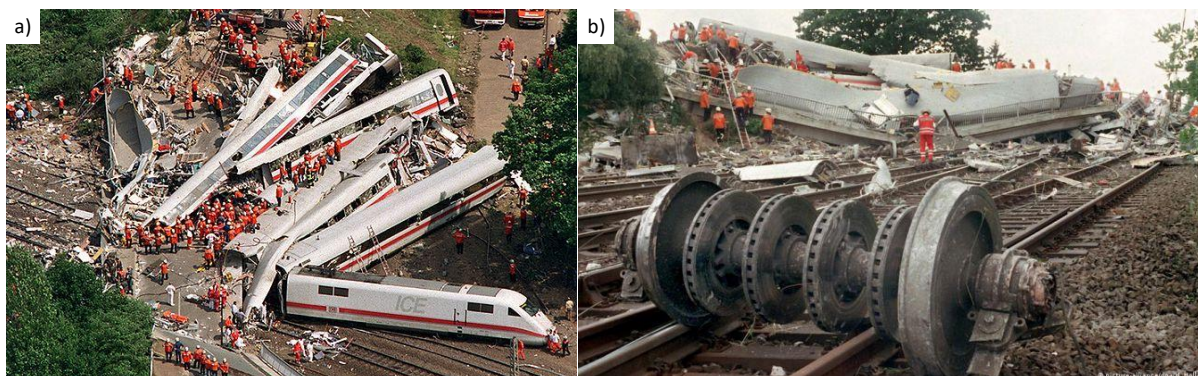
Rys. 4.1 Wypadek kolejowy w Eschede w dniu 3 czerwca 1998 r., a) widok pociągu Inter-Express ICE 884, b) widok zestawu kołowego w dniu wypadku [103, 104]
