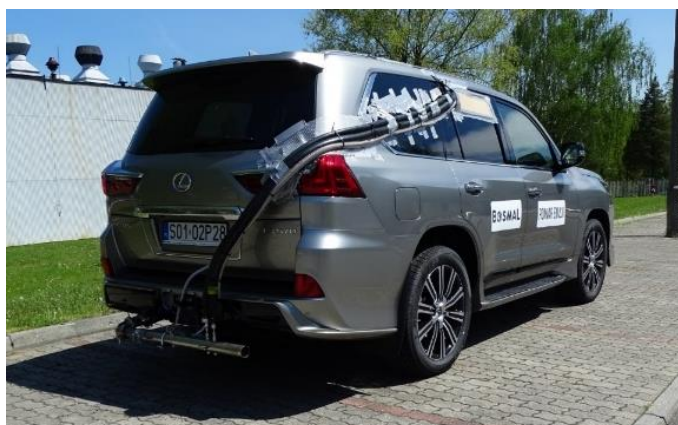
Rys. 2.17. Zewnętrzny systemu mobilnego zamontowany na samochodzie osobowym
