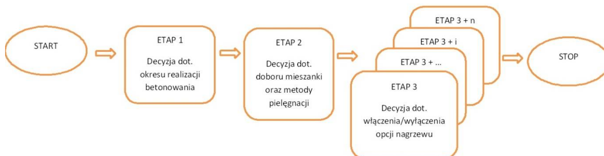
Rys. 5.2. Idea wieloetapowego procesu decyzyjnego w systemie COLCON
