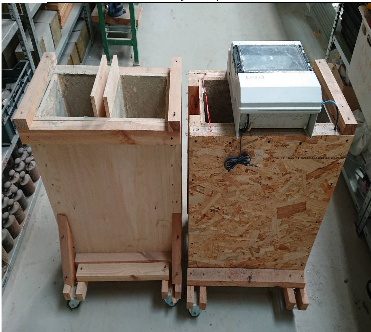
Fotografia nr L2. Formy do wykonania elementu ściany z elektronagrzewem Oraz z dwoma rodzajami mieszanki bez modyfikacji oraz modyfikowana PCM
