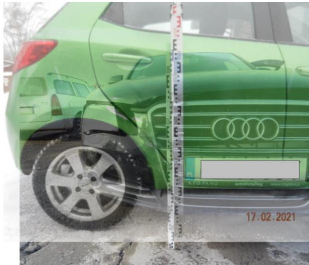
Rys. 7b. Zestawienie pojazdów przy zastosowaniu superpozycji transparentnej 2D
