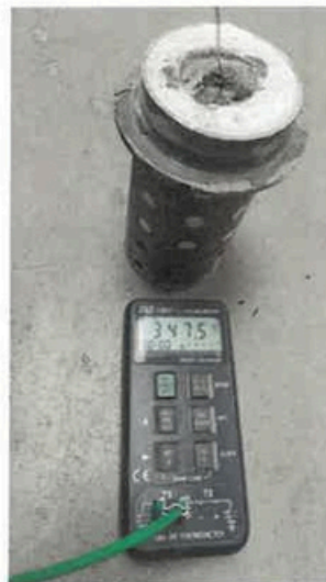
Rys. 32. Forma przed procesem zalewania.
