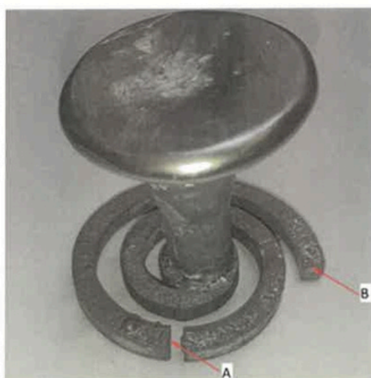
Rys. 26. Odlew po wybiciu z formy i oczyszczeniu z zaznaczonymi obszarami wycięcia próbek w celu oceny stopnia wypełnienia – miejsca pobrania próbek: \frac{1}{2} długości spirali (A), pole graniczne odlewu kompozytowego (B).
