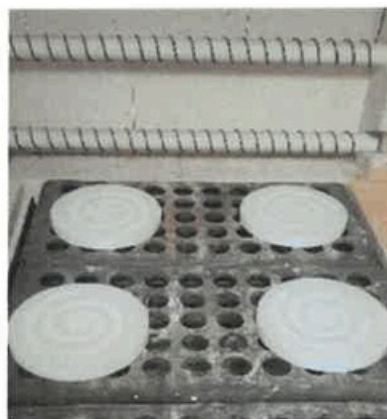
Rys. 22. Przygotowane matryce z masą do wytwarzania spieku przed procesem wypalania.
