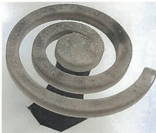
Rys. 23. Układ modelowy z kształtką zbrojenia przygotowany do formowania.
