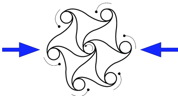
Rysunek 2.11: Mechanizm działania struktur chiralnych [Kolken, 2017].
