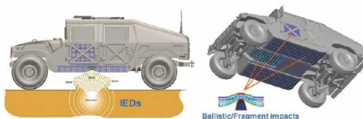
Rysunek 2.25: Potencjalne zastosowanie płyt auksetycznych do ochrony pojazdów przed wybuchem [Imbalzano i inni, 2017].
