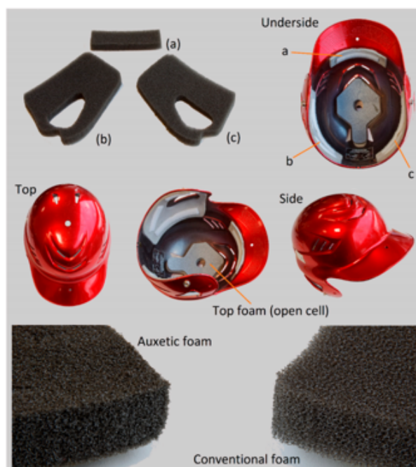
Rysunek 2.23: Propozycja wykorzystania pianek auksetycznych w konstrukcji kasków sportowych [Foster i inni, 2018].
