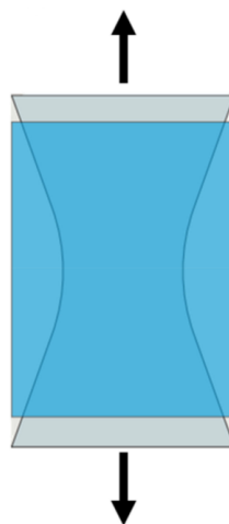
Rysunek 2.1: Zmiana przekroju obiektu z materiału o dodatnim współczynniku Poissona przy działaniu siły wzdłużnej [Bertoldi i inni, 2017].
