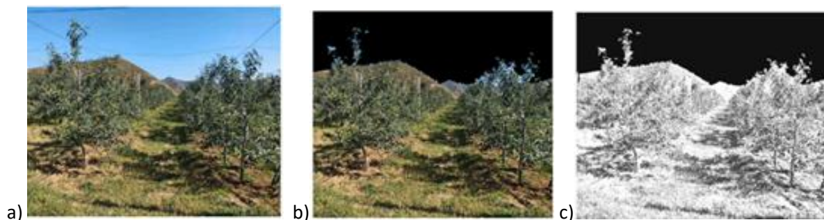
Rys. 2.32 Wstępne przetwarzanie obrazu: a) obraz RGB zarejestrowany przez kamerę, b) obraz z usuniętym niebem, c) obraz w skali szarości CIVE [100]
