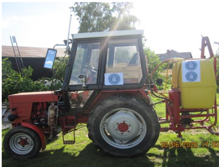
Rys. 4.1 Ciągnik Władimiriec T-25 po modernizacji z opryskiwaczem sadowniczym (opracowanie własne)
