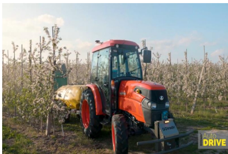
Rys. 2.10 Ciągnik i opryskiwacz sadowniczy z zainstalowanym systemem Auto Drive [49]
