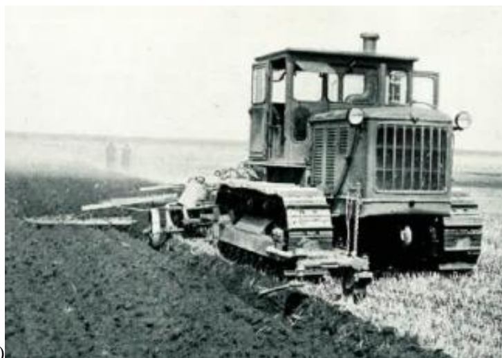
Rys. 2.5 Pierwsze wdrożenia ciągników bezzałogowych w rolnictwie: a) Ciągnik IMA zdalnie prowadzony ze stanowiska operatora [43], b) Ciągnik gąsienicowy S80 przystosowany do zdalnego prowadzenia [43]
