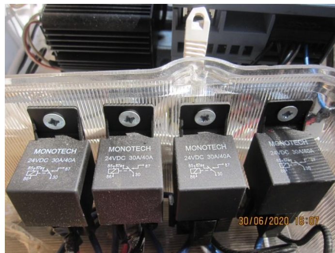
Rys. 4.7 Przekładniki elektromagnetyczne sterujące elementami wykonawczymi układu automatyki (opracowanie własne)
