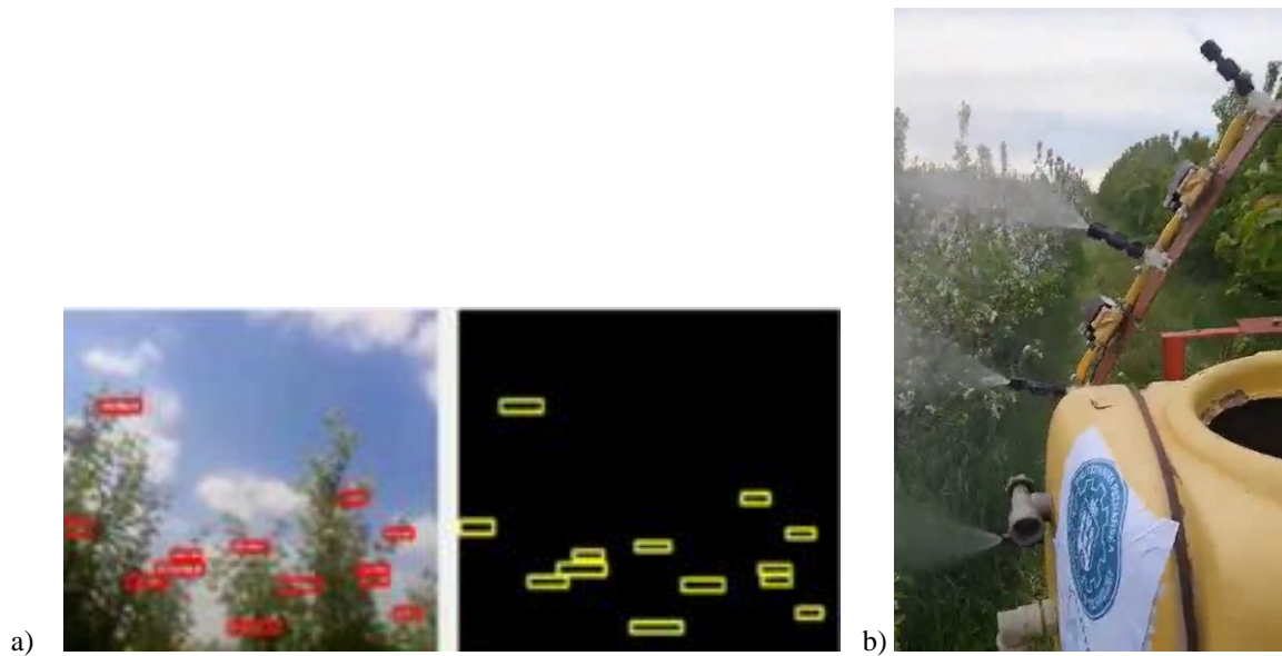
Rys. 4.18 a) wykrycie zarysu w strefie 2, b) przystawka z aktywną dyszą nr. 1,2 i 3 (opracowanie własne)
