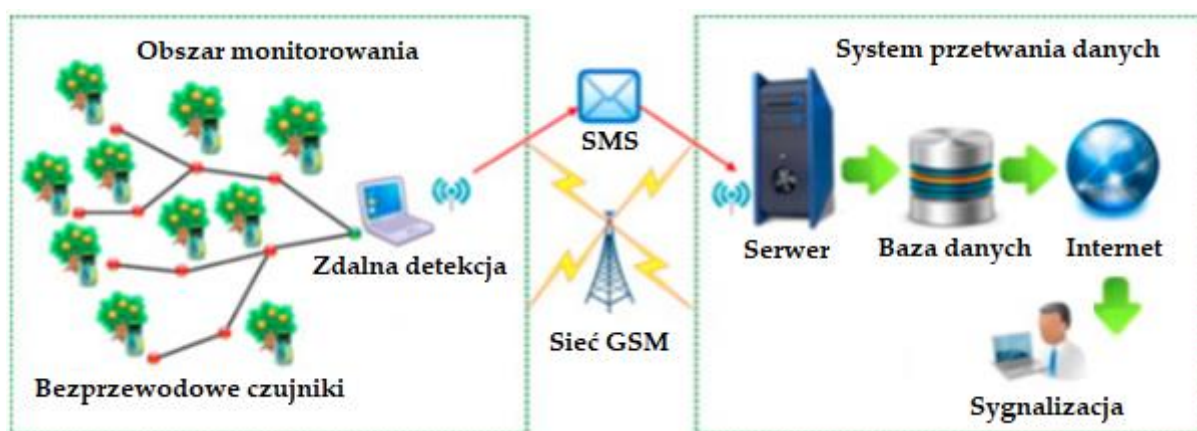
Rys. 2.18 System automatycznego monitorowania szkodników drzew owocowych [85]
