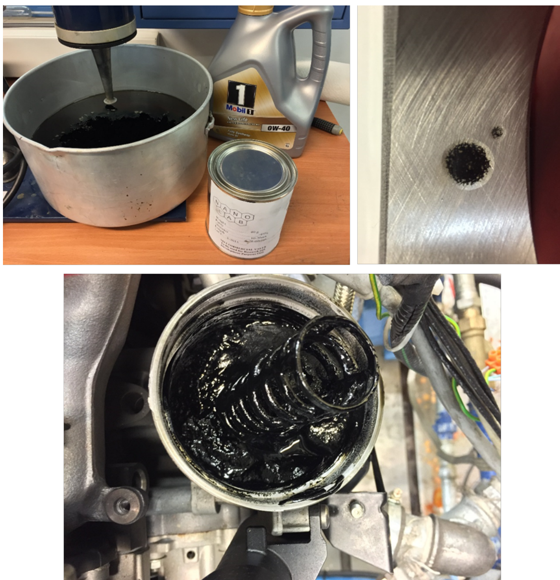
Rys. 6.1. Dyspergowanie CNTs w oleju za pomocą ultradźwięków, uzyskany efekt w postaci widocznych gołym okiem aglomeratów (widok kropel na gnieździe panwi łożyska wału korbowego) oraz smar uzyskany z tego samego oleju w czasie kilku minut pracy silnika; badania własne oraz [153]
