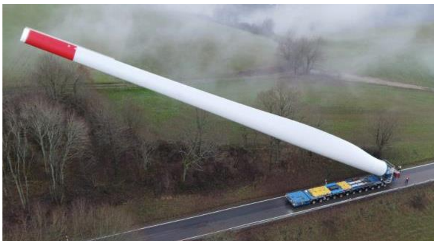
Rys. 47 Transport łopaty śmigła turbiny wiatrowej [62]
