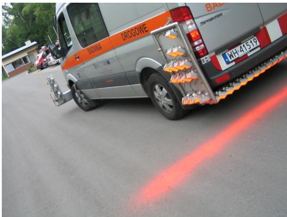
Rysunek 37. Oświetlenie LED gwarantuje wysoką jakość zdjęć powierzchni jezdni (źródło IBDiM)
