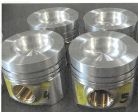
Rys. 17. Tłoki z wkładką kompozytową i naciętymi rowkami pod pierścień po obróbce wykończeniowej.
