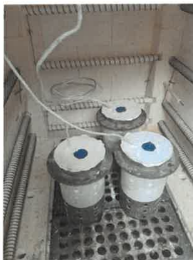
Rys. 24. Widok form umieszczonych w piecu przed procesem wyżarzania.
