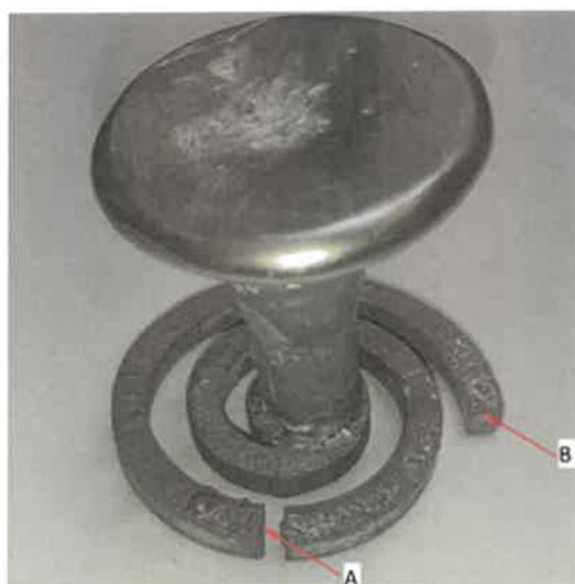
Rys. 26. Odlew po wybijaniu z formy i oczyszczeniu z zaznaczonymi obszarami wycięcia próbek w celu oceny stopnia wypełnienia – miejsca pobrania próbek: \frac{1}{2} długości spirali (A), pole graniczne odlewu kompozytowego (B).
