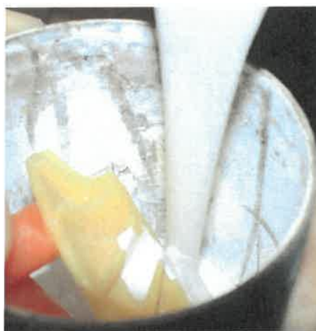
Rys. 2. Proces wykonania formy: zalewanie układu modelowego masą gipsową.
