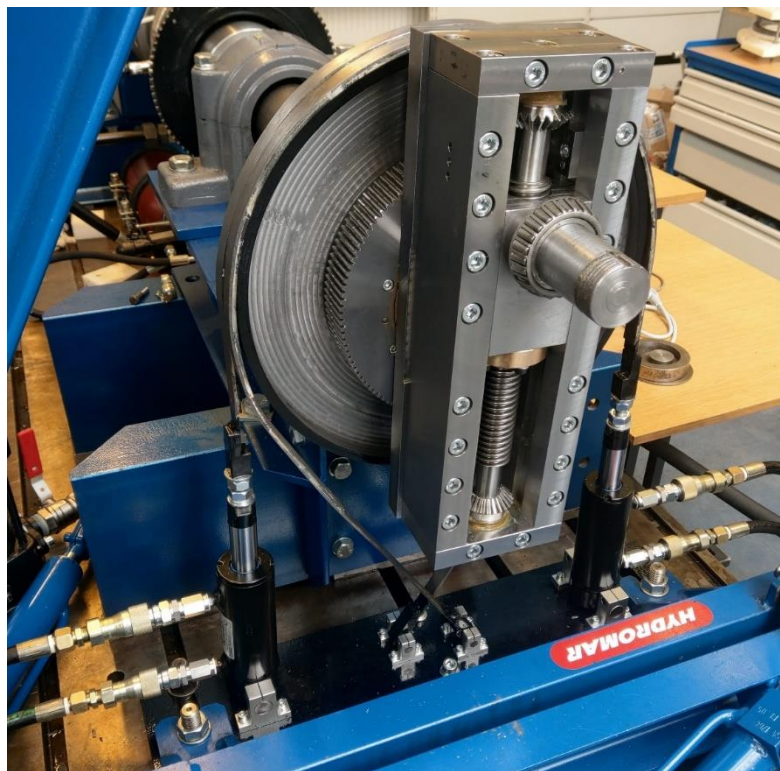
Rysunek 38. Widok prototypu mechanizmu zmiany mimośrodu wraz z układem hamulcowym
