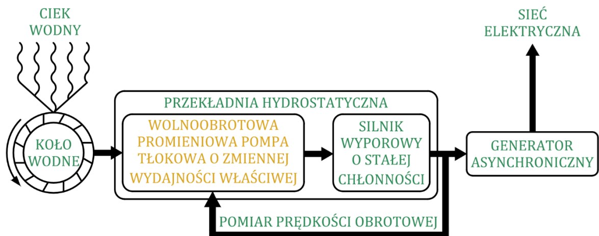
Rysunek 17. Schemat MEW z przekładnią hydrostatyczną
