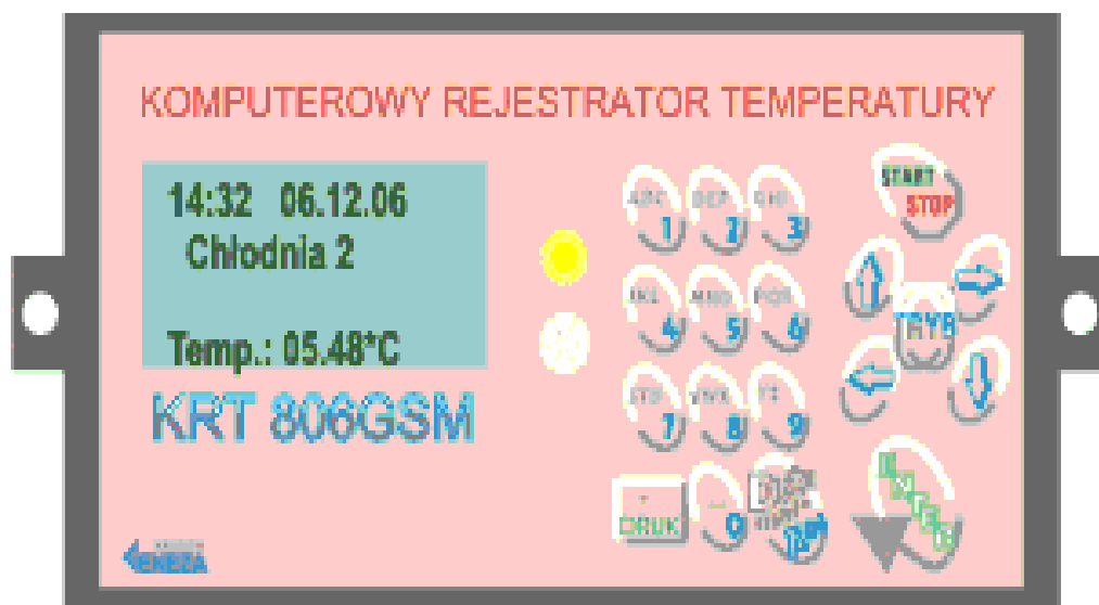
Rysunek 6.4. Rejestrator Geneza KRT-806 GSM 8 kanałowy przewodowy
