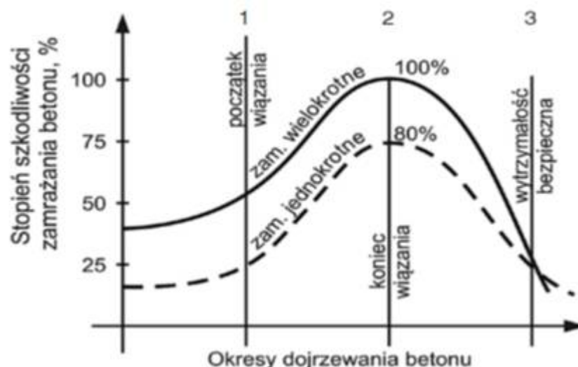
Rysunek 1 Wpływ zamarznięcia betonu w okresie dojrzewania na końcową wytrzymałość
