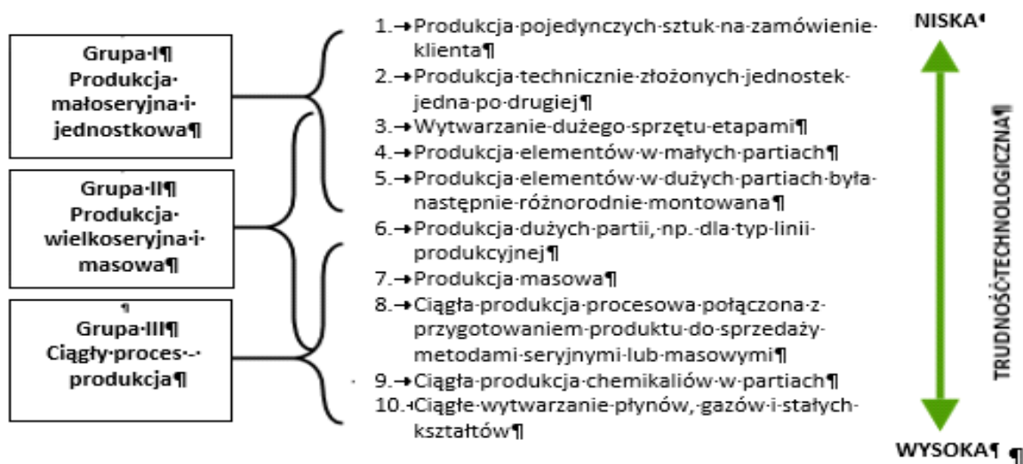
Rysunek 2.2. Klasyfikacja systemów produkcyjnych wg Woodward'a
