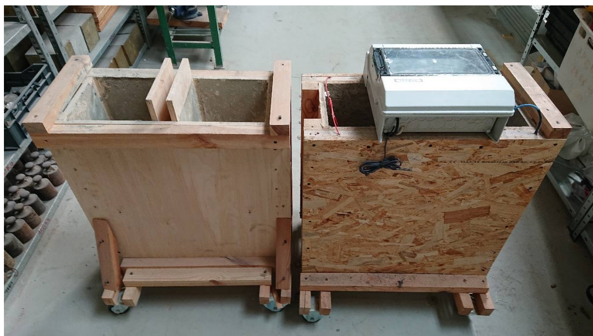
Fotografia nr L2. Formy do wykonania elementu ściany z elektronagrzewem
