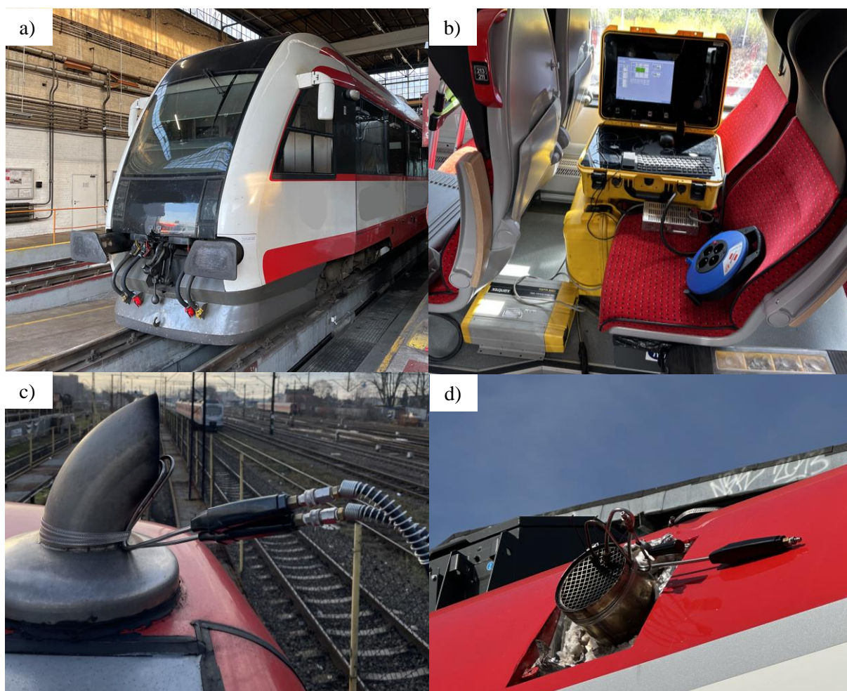
Rys. 5.3. Badania związków szkodliwych – a) przykładowy obiekt badawczy, b) aparatura pomiarowa do badań związków szkodliwych spalin w rzeczywistych warunkach eksploatacji, c) układ sondy pomiarowej pojazdu I, d) układ sondy pomiarowej pojazdu II
