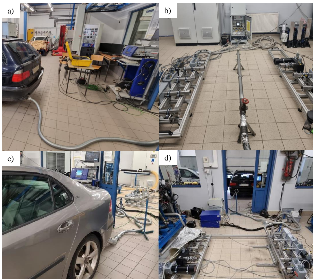
Rys. 5.4. Badania związków szkodliwych spalin – a) stanowisko pomiarowe do badań związków szkodliwych spalin w warunkach stacjonarnych, b) układ sondy pomiarowej, c) brama emisyjna wraz z widokiem na obiekt badawczy, d) widok układu pomiarowego
