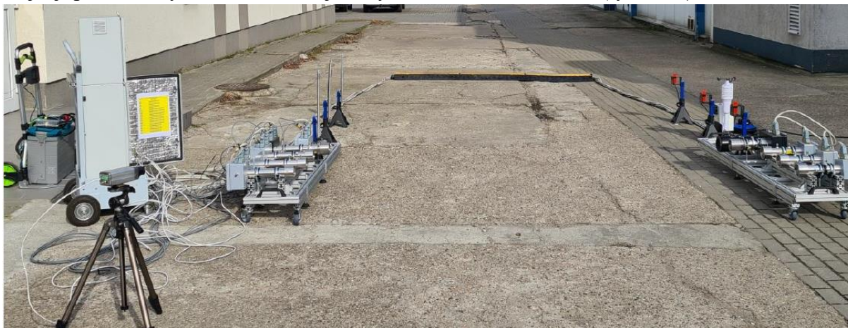
Rys. 5.12. Widok kompletnej bramy emisyjnej na drodze utwardzonej
