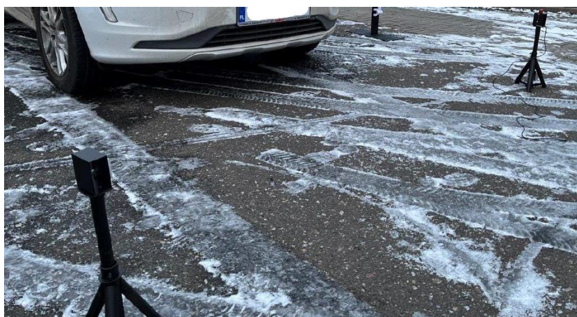
Rys. 5.19. Widok optycznych, odbiciowych czujników podczas testów
