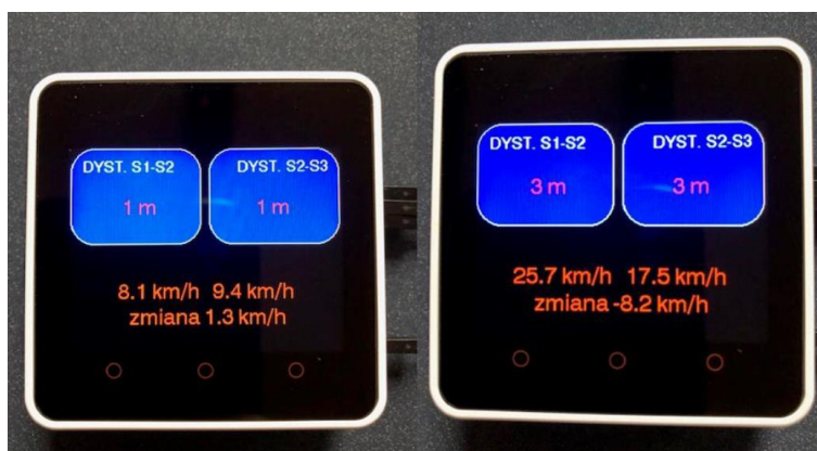
Rys.5.20. Widok ekranu urządzenia podczas zmiany prędkości pojazdu na odcinku badawczym
