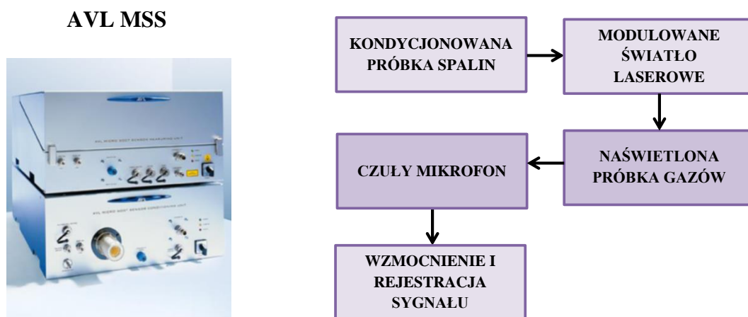
Rys. 5.10 Widok urządzenia oraz schemat działania aparatury AVL MSS [6]
