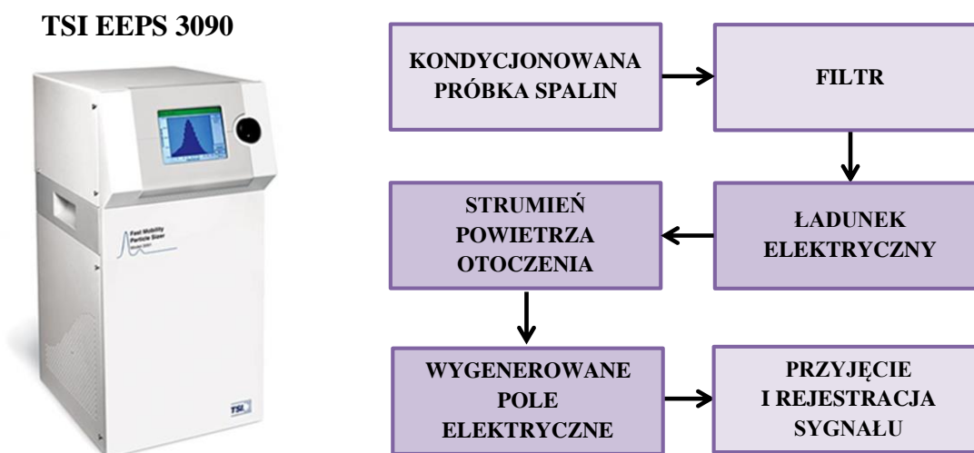
Rys. 5.11 Widok urządzenia oraz schemat działania aparatury TSI EEPS 3090 [164]
