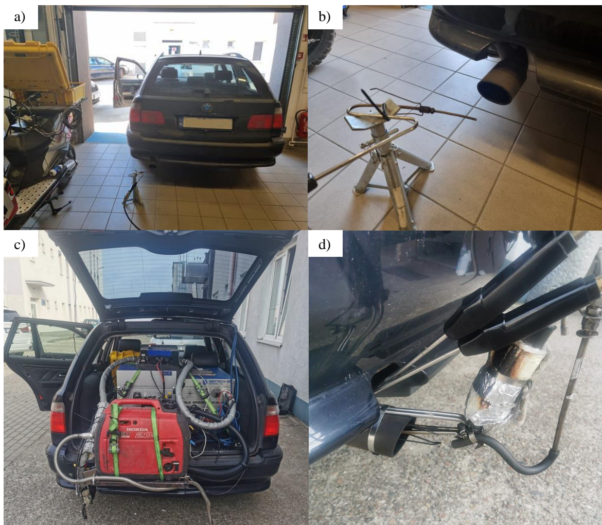
Rys. 5.2. Badania związków szkodliwych – a) stacjonarny pomiar stężenia związków szkodliwych spalin, b) układ sondy pomiarowej przy badaniach stacjonarnych, c) dynamiczny pomiar stężenia związków szkodliwych spalin, d) układ sondy pomiarowej przy badaniach dynamicznych
