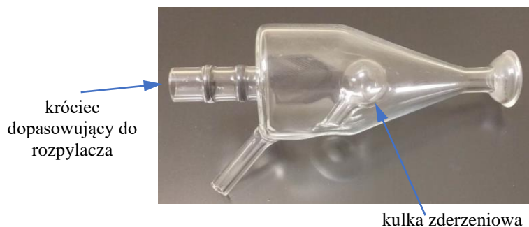
Rysunek 14. Komora mgielna z kulką zderzeniową.
