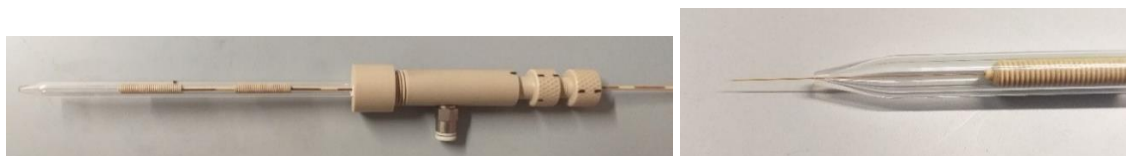
Rysunek 10. Mikrorozpylacz D-DIHEN wraz z dyszą wylotową (z prawej).
