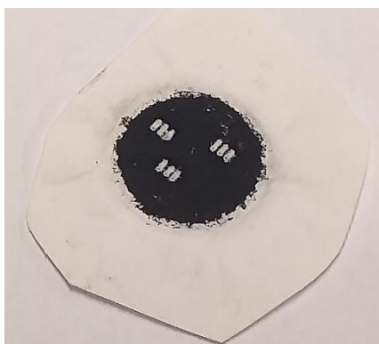
Rysunek 50. Próbką po odparowaniu laserowym.
