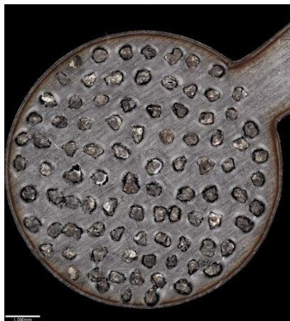
Rysunek 4.5. Monowarstwowa jednostronna ściernica cBN o zdefiniowanym ułożeniu ziaren ściernych (oprac. własne)
