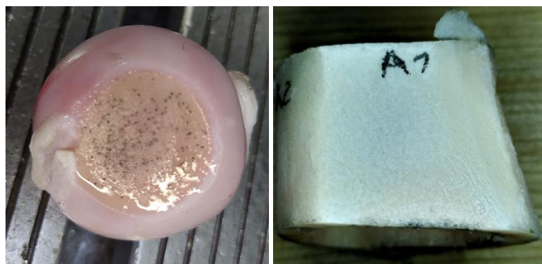
Rysunek 2.57. Powierzchnia głowy kości udowej (z pozostałościami ziaren ściernych) oraz trzonu kości udowej po obróbce ścierniej (oprac. własne)
