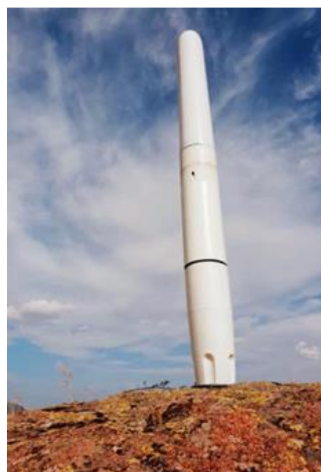
Rys. 1.3.5b. Bladeless Vortex w trakcie pracy [43]
