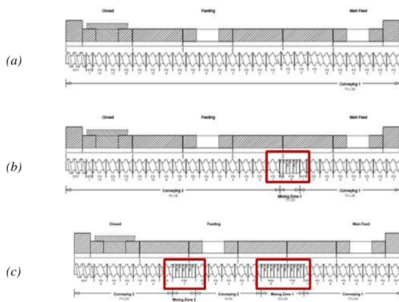
Rys. 4.4.4. Konfiguracje ślimaka stosowane podczas procesu HME: a) I- bez strefy mieszania, b) II- z jedną strefą mieszania, c) III z dwiema strefami mieszania.
