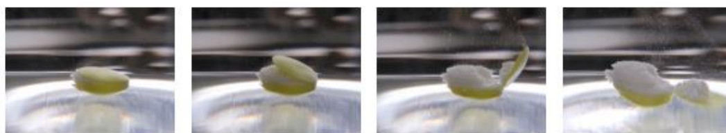
Rys. 4.4.7. Etapy rozpadu tabletki z powlekaną otoczką Eudragit RLPO [160].
