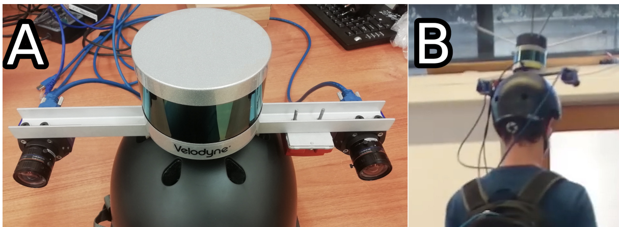
Rysunek 6: Układ eksperymentalny z dwiema kamerami MV BlueFox3-2016C-1112 i Velodyne VLP-16 LiDAR bez wyzwalania sprzętowego (A), który został wykorzystany do mapowania wewnątrz pomieszczeń po zamontowaniu na kasku (B).
