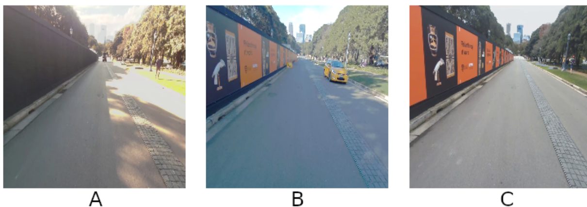
Rysunek 14: Przykładowa lokalizacja widoczna w różnych momentach: rozwiązanie oparte na LiDAR działa pewniej w przypadku większej struktury i intensywnego słońca (A), podobna wydajność wersji opartej na kamerze i LiDAR w typowych warunkach (B) oraz wersja oparta na kamerze przewyższająca LiDAR w idealnych warunkach oświetleniowych (C).
