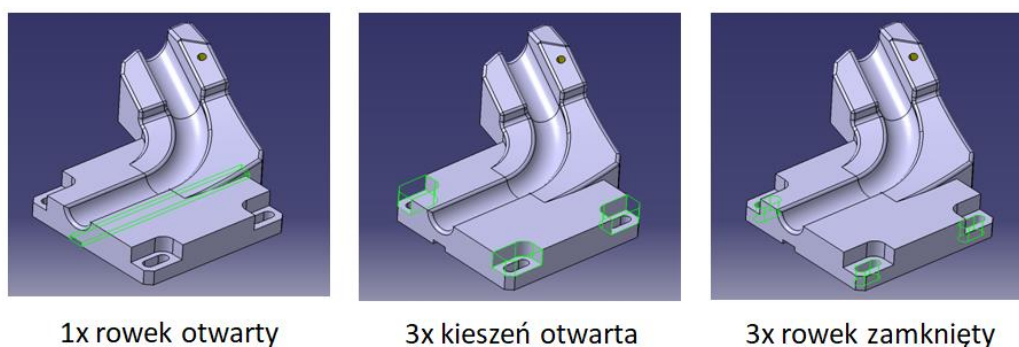
Rys. 3.10 Cechy geometryczne modelu formy rozpoznane automatycznie przez funkcję FR systemu CATIA [opracowanie własne]
