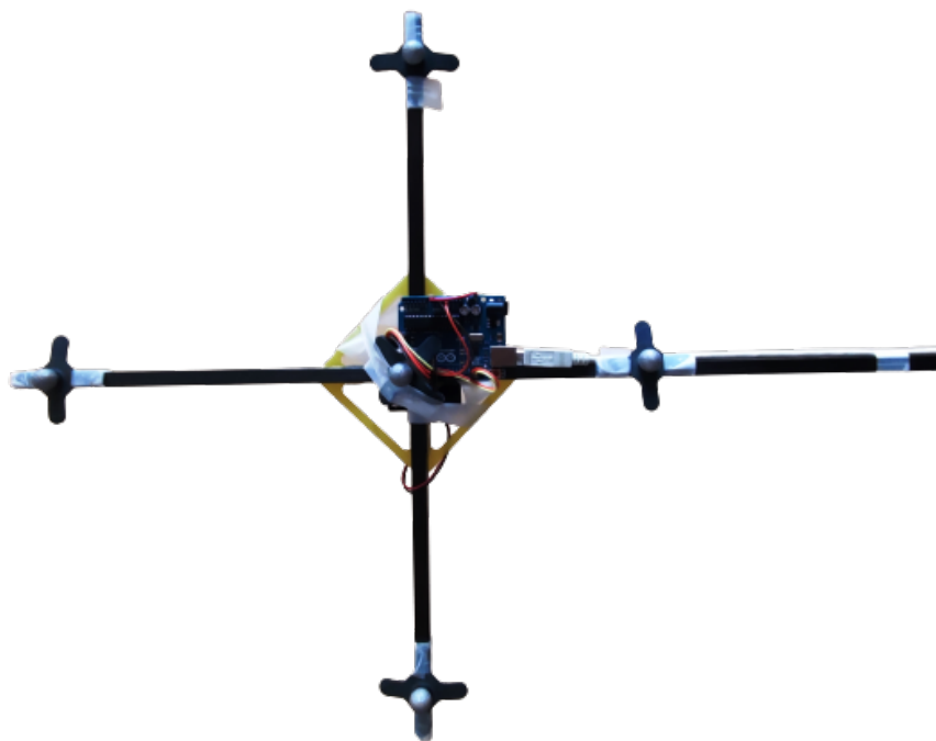
RYSUNEK 4.7: Drugie urządzenie do akwizycji danych oparte o IMU 9-DOF BNO080 wraz z płytką Arduino UNO oraz widocznymi znacznikami systemu OptiTrack
