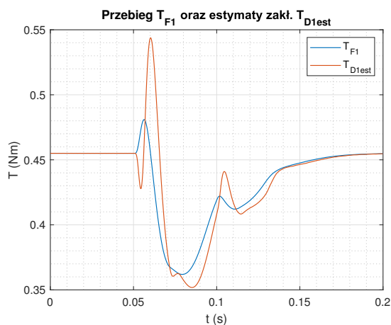
(c) Przebieg całkowitego momentu zakłócającego po stronie silnika
