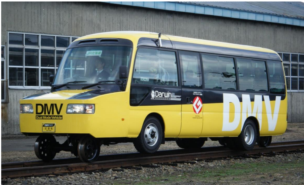
Rys. 1.11. Pojazd Dual Mode Vehicle (DMV) przeznaczony do przewozu osób podczas eksploatacji w systemie kolejowym [33]
