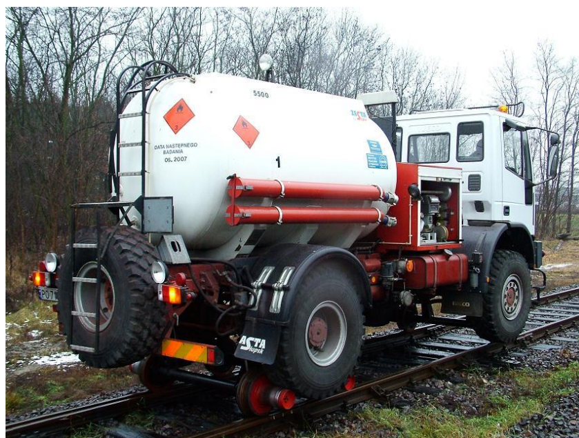
Rys. 3.1. Pojazd szynowo-drogowy IVECO w trakcie eksploatacji torowej [88]
