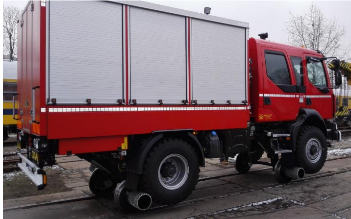
Rys. 1.7. Pojazd szynowo-drogowy wchodzący w skład Specjalnego Pociągu Ratownictwa Technicznego (SPRT) [15]
