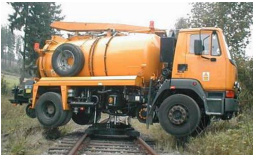
Rys. 1.5. Pojazd szynowo-drogowy DAF 4x2 FA 60 DRAINLINER wyposażony w podnośnik-obrotnicę w trakcie ustalania kierunku jazdy [20]
