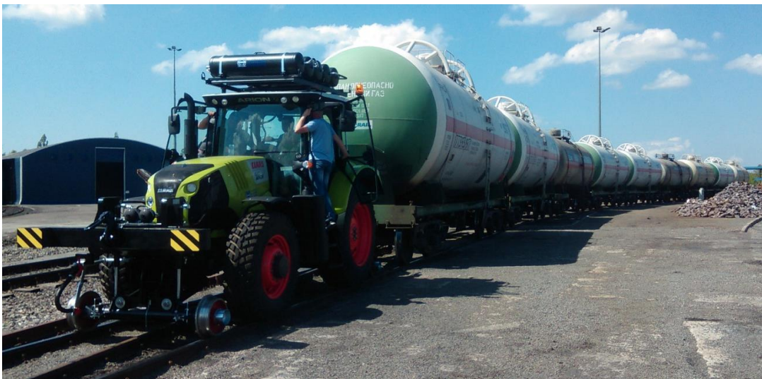
Rys. 1.6. Ciągnik s-d. CLAAS ARION 620 wykonujący prace manewrowe ze składem wagonów [13]
