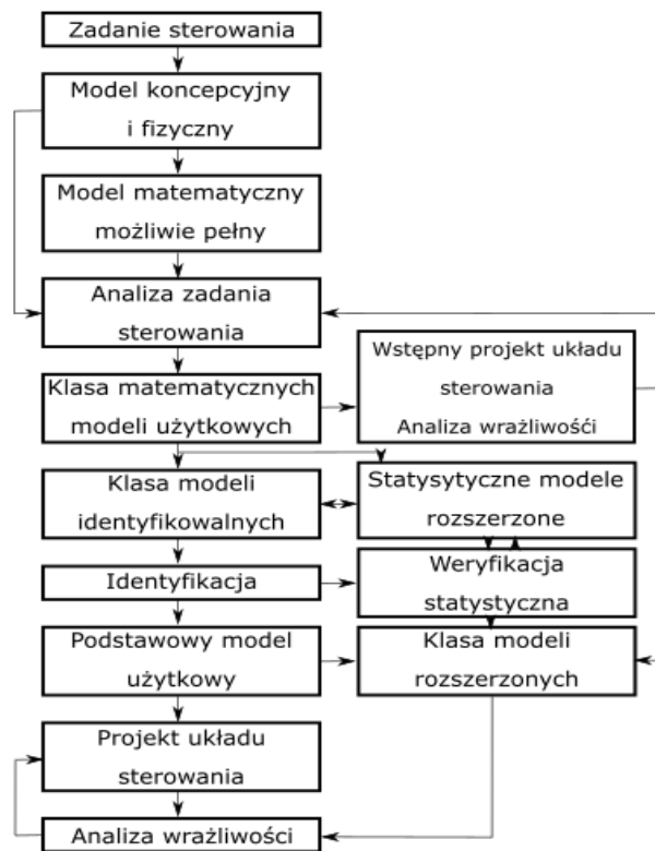
Rys. 5.12: Schemat postępowania przy budowie i wykorzystaniu modelu procesu sterowanego [83].
