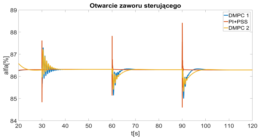
Rys. 7.30: Otwarcie zaworu sterującego (wielkość sterująca) dla dwóch różnych regulatorów DMPC 1 i DMPC 2 (skok napięcia SEE o 5%) - rozwiązanie klasyczne jako tło.
