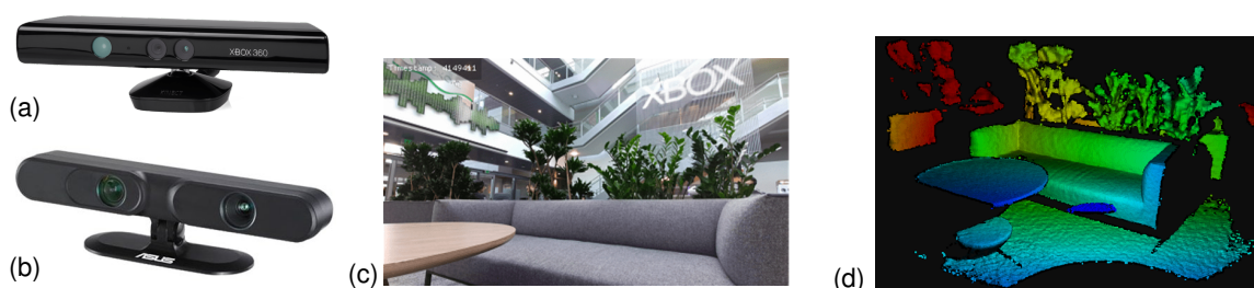
Rysunek 2.9: Przykłady systemów aktywnych: (a) Kinect [298], (b) Xtion [12]. (c) Przykładowy obraz z kamery RGB. (d) Chmura punktów uzyskana za pomocą sensora Kinect dla przestrzeni pokazanej na rysunku (c) [183].
