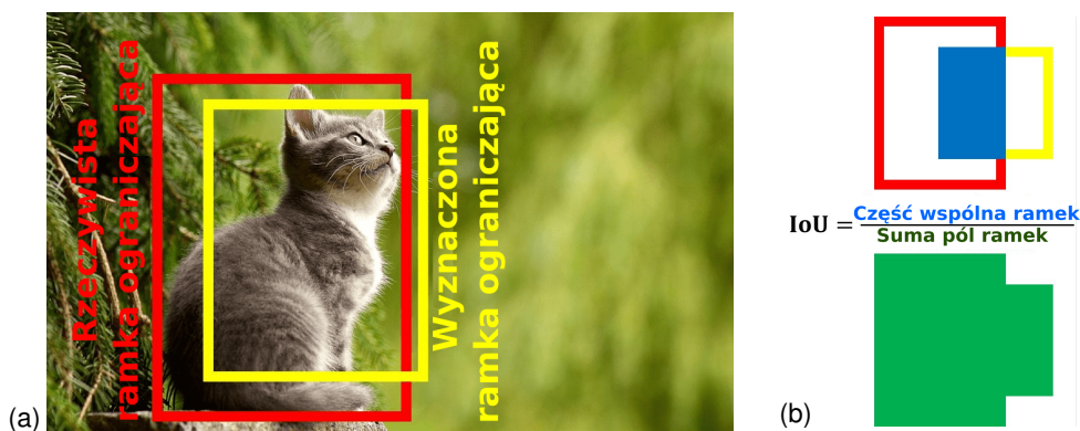
Rysunek 3.16: (a) Obraz z ramką prognozowaną i ramką rzeczywistą. (b) Wzór na wskaźnik IoU. Źródło [87].
