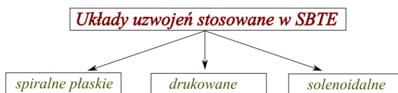
Rys. 2.3.1. Podstawowy podział układu uzwojeń stosowanych w SBTE
