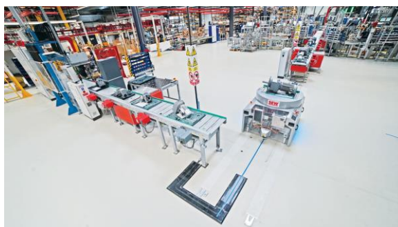
Rys. 2.2.16 Samojezdny wózek transportowy zasilany bezprzewodowo [173]
