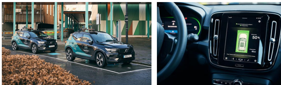
Rys. 2.2.3 System bezprzewodowego ładowania baterii samochodów elektrycznych w mieście [167]
