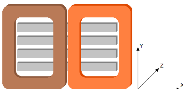
Rys. 2.3.5. Konfiguracja DD cewki spiralnej płaskiej
