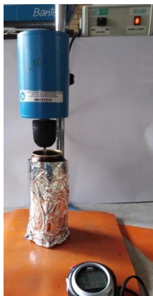
Rys. 4.1. Homogenizator laboratoryjny o prędkości kątowej 400 obr./min podczas mieszania próbki asfaltu modyfikowanego polimerem
