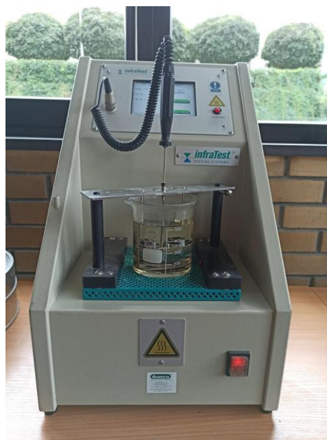
Rys. 5.6. Automatyczny aparat do oznaczania temperatury mięknienia wg metody „Pierścień i Kula”
