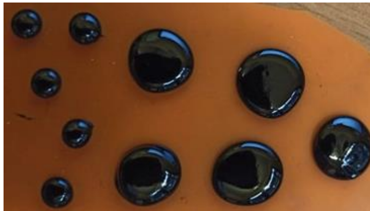
Rys. 5.9. Komplet próbek asfaltu modyfikowanego 3%SBS do badania w reometrze DSR o średnicy \varnothing 25 oraz \varnothing 8 mm na podkładce silikonowej
