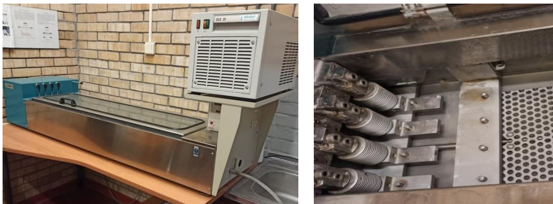
Rys. 5.14. Duktylometr wraz z zestawem ogrzewająco-chłodzącym (a) oraz mechanizm rozciągający (b)
