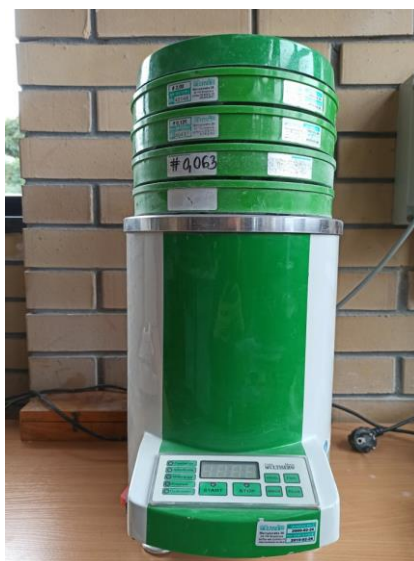
Rys. 5.1. Aparat do przesiewania wypełniacza w strumieniu powietrza
