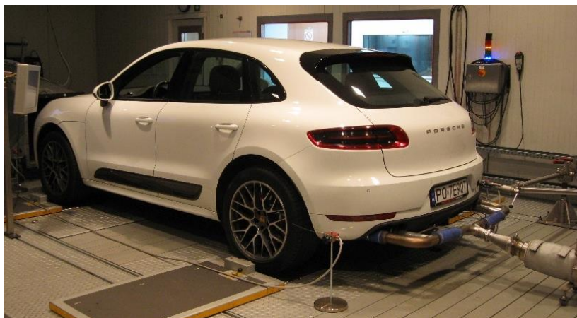
Rys. 6.5. Widok układu poboru spalin podczas badań na hamowni
