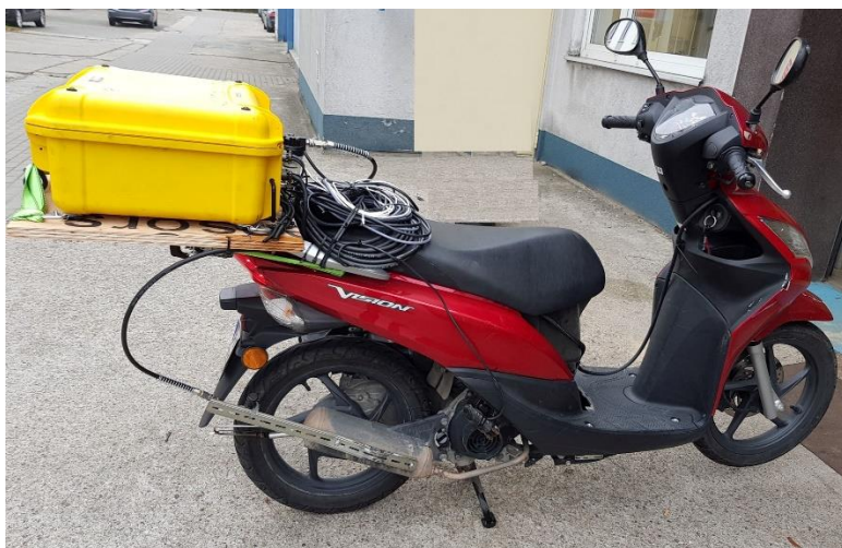
Rys. 7.1. Przykład badania pojazdu jednośladowego aparaturą PEMS [98]
