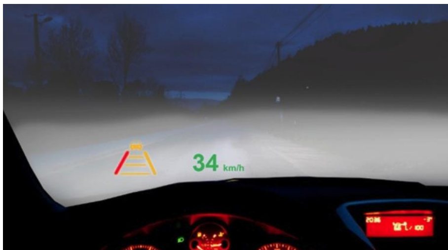
Rys. 3.12. Przykład wyświetlacza typu head-up w pojazdach osobowych [90]
