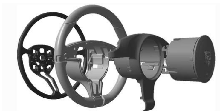
Rys. 3.8. Schemat podstawowej wersji kierownicy pojazdu osobowego [103]
