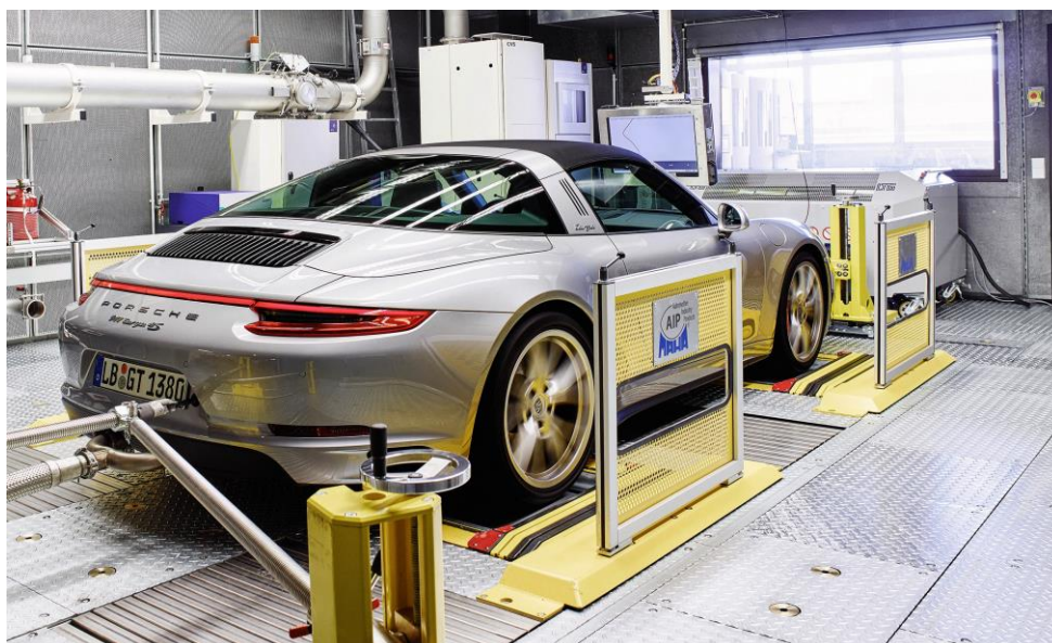
Rys. 2.5. Badanie emisji na hamowni podwoziowej [54]
