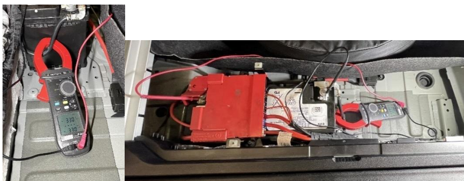
Rys. 5.3. Sposób przeprowadzania pomiarów zużycia prądu w pojeździe SUV ZS
