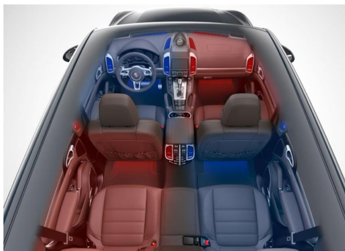
Rys. 3.2. Przykład czterostrefowego układu klimatyzacji [54]
