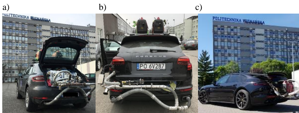
Rys. 7.6. Widok pojazdów wraz z aparaturą badawczą: a) SUV ZI 4, b) SUV ZS 2, c) hybryda
