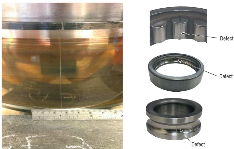
Rys. 2.4. Przykład 2; łożyska z intencjonalnie wprowadzonymi uszkodzeniami [26, 88]
