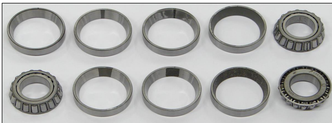
Rys. 3.7. Wybrane, uszkodzone łożyska z zestawu łożysk A [fot autor]
