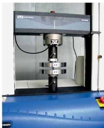
Rys. 17. Uniwersalna maszyna wytrzymałościowa Instron 3369 [109]
