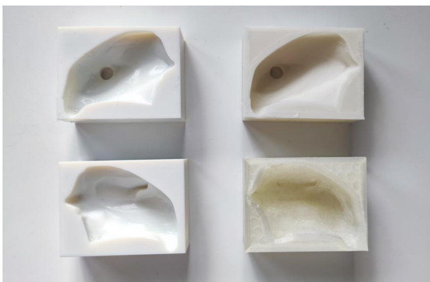
Rys. 5.7 Dwuczęściowe formy dla modelu narządu z guzem; (L) forma wytworzona metodą PolyJet, (P) forma wytworzona metodą FDM (opracowanie własne)
