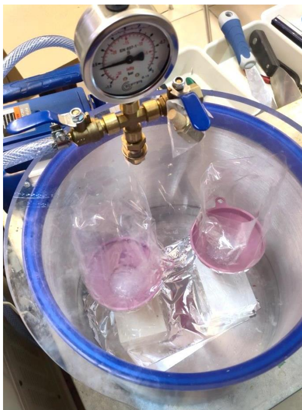
Rys. 4.28 Proces odgazowania materiału w formie, widoczne nabudowanie ścianek lejka taśmą (opracowanie własne)
