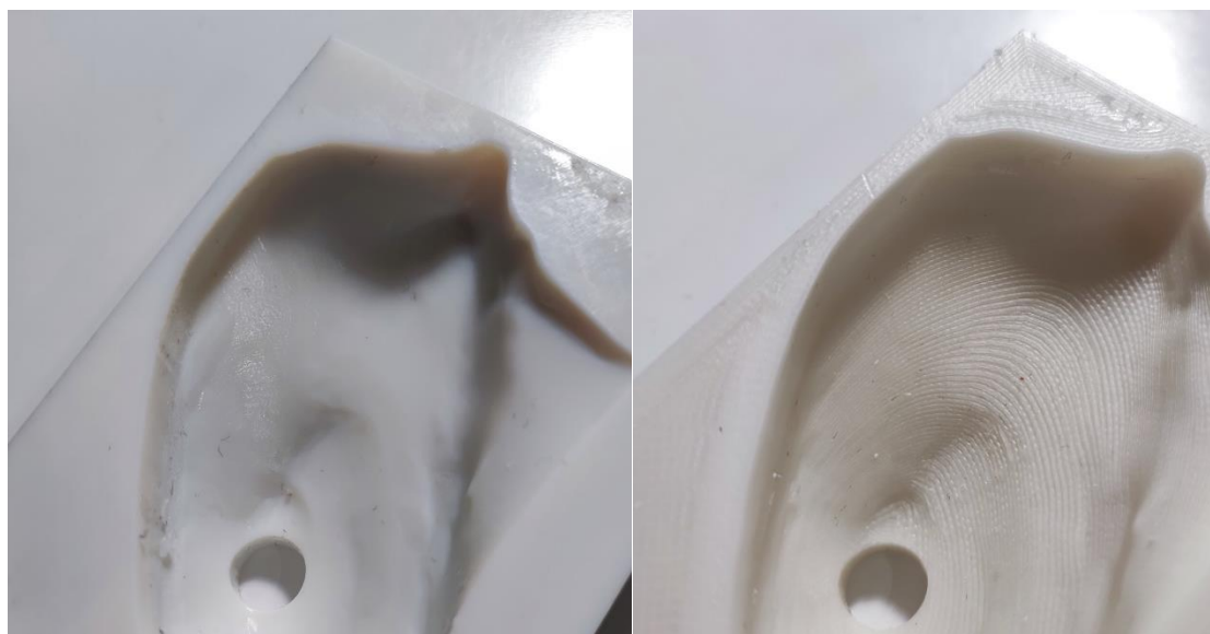
Rys. 5.12 Porównanie powierzchni wnęk form; (L) forma wytworzona metodą PolyJet, (P) forma wytworzona metodą FDM (opracowanie własne)
