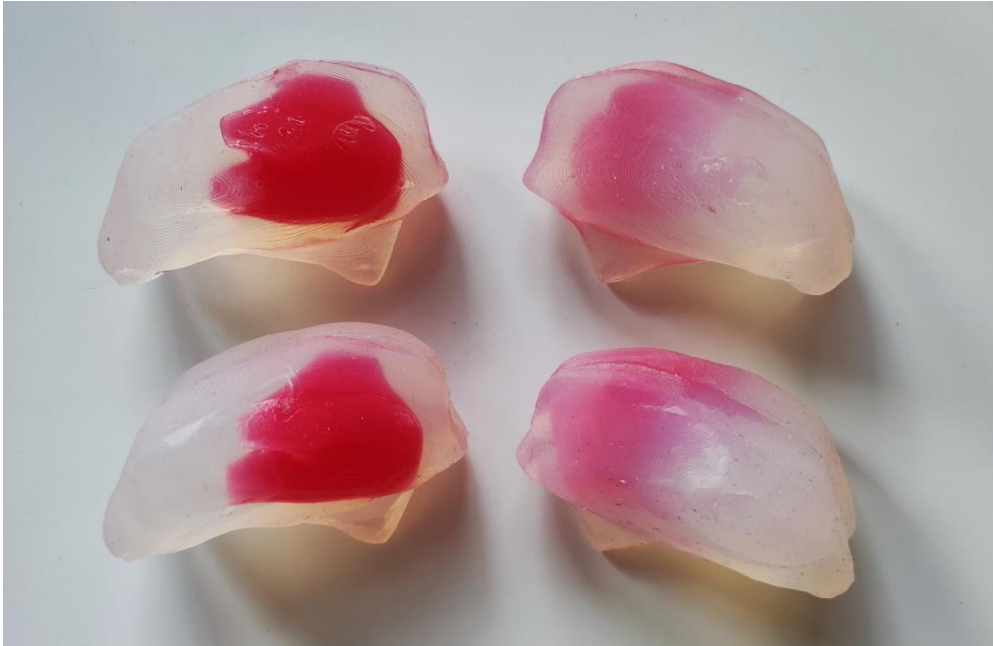
Rys. 5.20 Porównanie modeli wytworzonych w formie FDM i PolyJet z połączenia materiałowego Sorta Clear 12 + Slacker i Sorta Clear 37; (góra) modele z formy FDM, (dół) modele z formy PolyJet (opracowanie własne)
