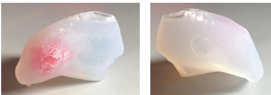
Rys. 5.15 Model dla selekcji materiałowej, wytworzony w formie FDM o połączeniu materiałowym Sorta Clear 12 + XTX 45 wg. strategii PRZED [Jezińska, 2021]
