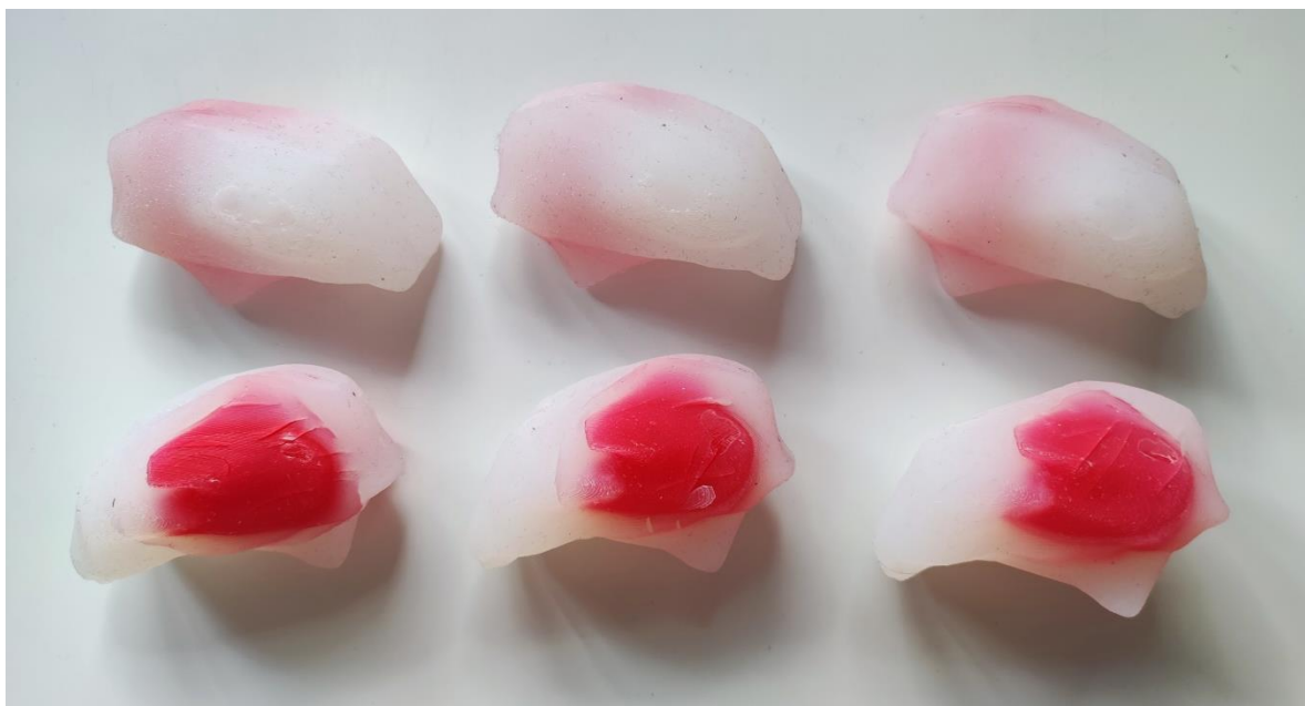
Rys. 5.19 Wyroby końcowe wytworzone w formie FDM o połączeniu materiałowym EcoFlex 00-20 i Sorta Clear 37; (L) model nieodgazowany (strategia BRAK), (Ś) model odgazowany w formie (strategia PO), (P) model odgazowany przed zalaniem (strategia PRZED) (opracowanie własne)
