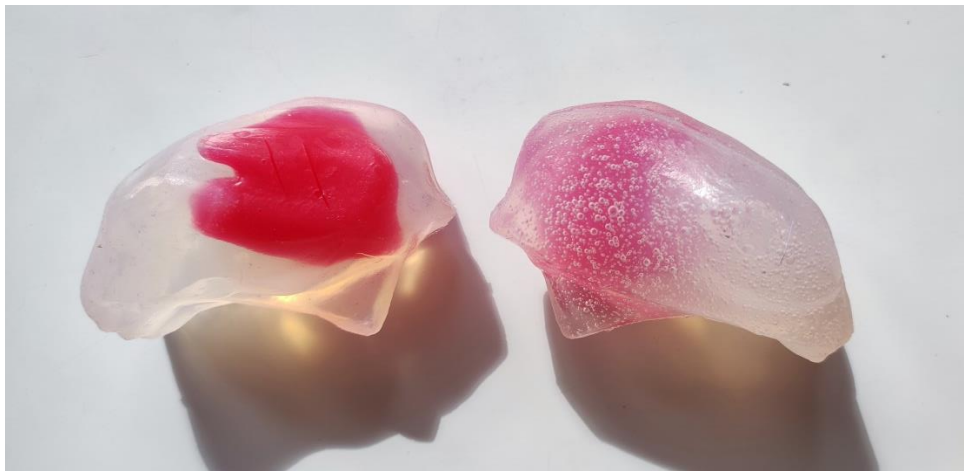
Rys. 5.21 Porównanie modeli wytworzonych w formie PolyJet z połączenia materiałowego Sorta Clear 12 i Sorta Clear 37; (L) model wytworzony strategią PRZED, (P) model wytworzony strategią BRAK; (opracowanie własne)
