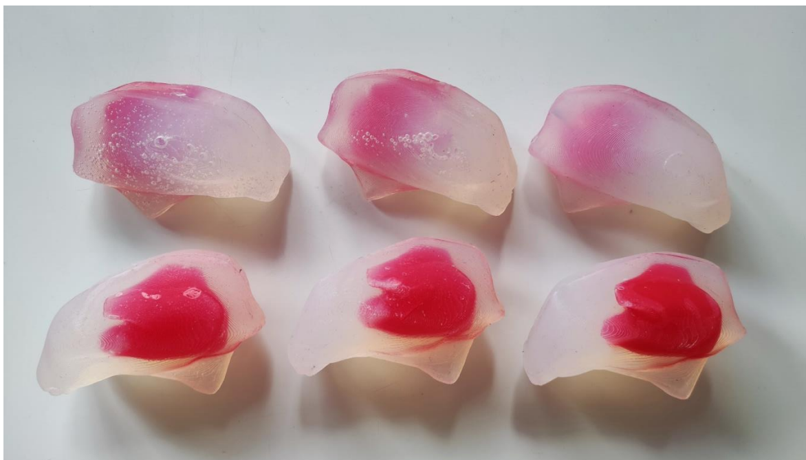
Rys. 5.16 Wyroby końcowe wytworzone w formie FDM o połączeniu materiałowym Sorta Clear 12 i Sorta Clear 37; (L) model nieodgazowany (strategia BRAK), (Ś) model odgazowany w formie (strategia PO), (P) model odgazowany przed zalaniem (strategia PRZED) (opracowanie własne)
