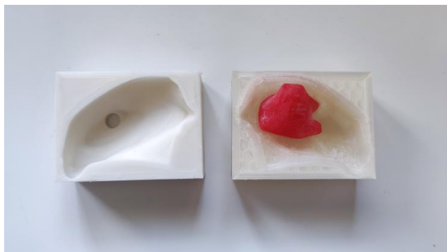
Rys. 4.26 Model guza umieszczony w formie dla modelu dwumateriałowego (opracowanie własne)
