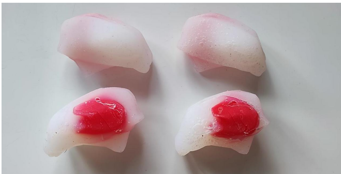
Rys. 5.18 Wyroby końcowe wytworzone w formie FDM o połączeniu materiałowym Dragon Skin 10 Very Fast i Sorta Clear 37; (L) model odgazowany przed zalaniem (strategia PRZED), (P) model nieodgazowany (strategia BRAK) (opracowanie własne)
