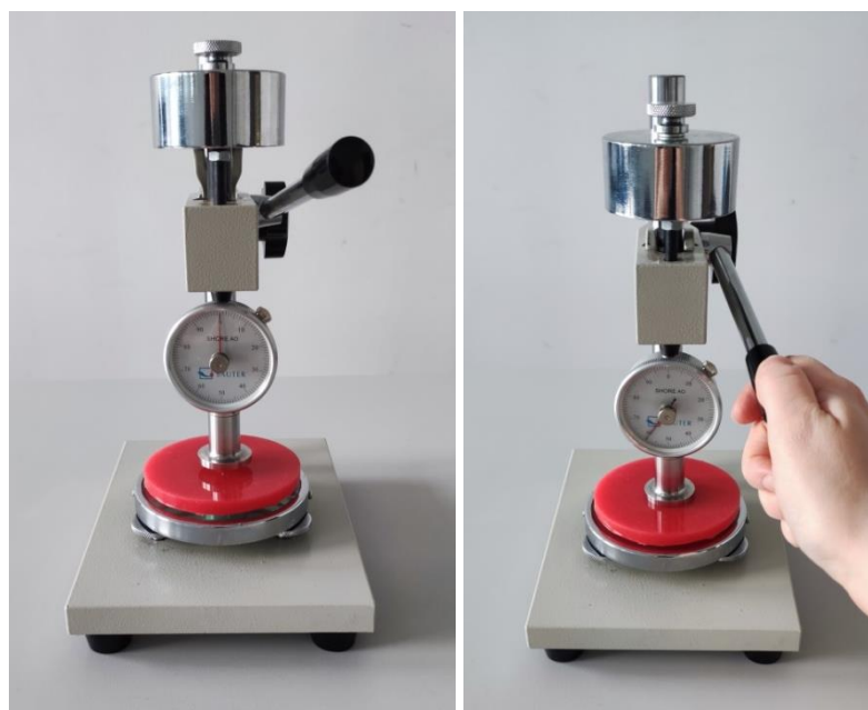
Rys. 4.19 Badanie twardości próbki w skali Shore A0 przy użyciu durometru 100 – 0 HB0 (opracowanie własne)
