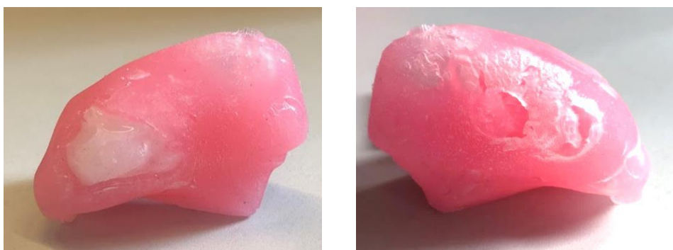
Rys. 5.13 Model dla selekcji materiałowej, wytworzony w formie FDM o połączeniu materiałowym Sorta Clear 12 + TPU wg. strategii BRAK [Jezińska, 2021]
