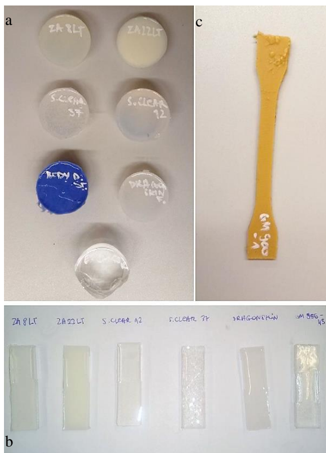
Rys. 4.15 Przykładowe próbki wybranych materiałów; a) próbki docięcia głębokiego, b) próbki imitujące powłoki, c) przykład próbki żywicy GM 956-45
