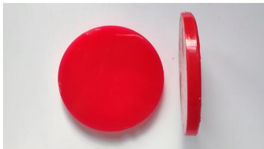
Rys. 4.18 Próbką barwiona dla badań twardości silikonu (opracowanie własne)
