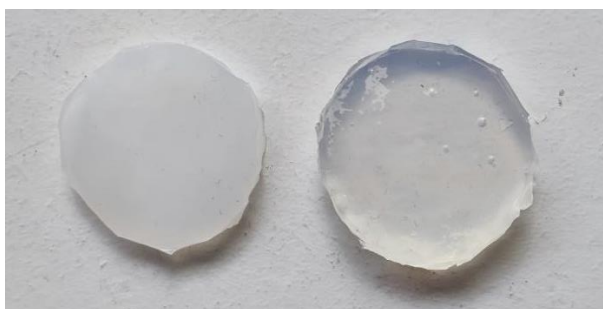
Rys. 4.20 Przykładowe próbki dla dwóch silikonów: o większym stopniu zamglenia (L) i niskim (P) (opracowanie własne)
