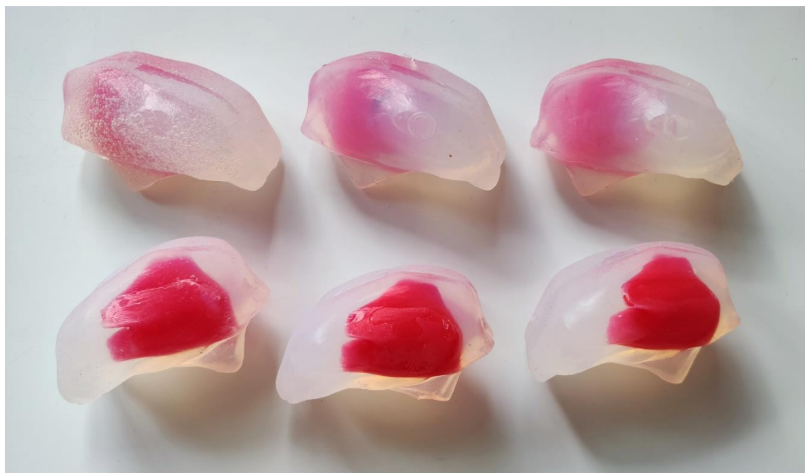
Rys. 5.17 Wyroby końcowe wytworzone w formie PolyJet o połączeniu materiałowym Sorta Clear 12 i Sorta Clear 37; (L) model nieodgazowany (strategia BRAK), (Ś) model odgazowany w formie (strategia PO), (P) model odgazowany przed zalaniem (strategia PRZED) (opracowanie własne)
