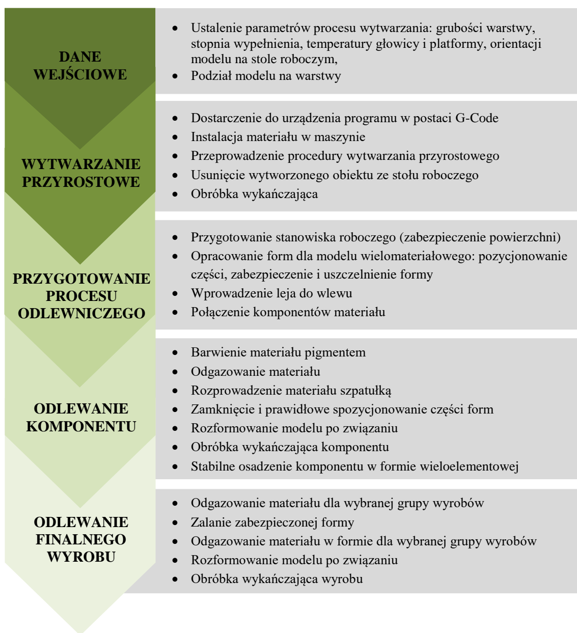
Rys. 4.21 Przebieg wytwarzania wyrobów i oprzyrządowanie (opracowanie własne)
