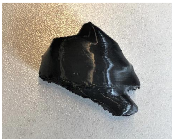
Rys. 5.11 Model guza wytworzony metodą FDM z materiału gumowego – TPU [Jezińska, 2021]
