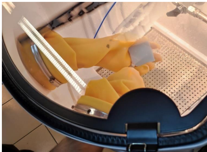
Rys. 4.24 Oczyszczanie modelu z materiału podporowego przy użyciu wody pod ciśnieniem (opracowanie własne)
