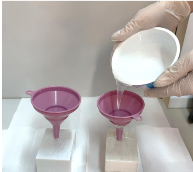
Rys. 4.27 Proces zalewania formy całego modelu odgazowanym materiałem (opracowanie własne)
