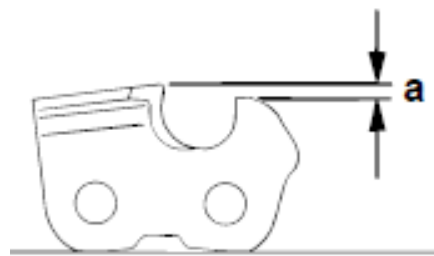
Rysunek 4.6 Sposób pomiaru rozmiaru szczeliny wrębowej [116]
