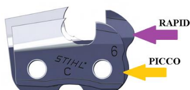
Rysunek 4.7 Różnica profili wysokościowych łańcuchów tnących marki STIHL [116]
