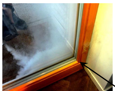
Rys. 4–11. Przeciek powietrza przez ramę okienną
