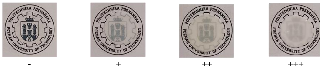
Rys. 37. Zdjęcia jonożeli obrazujące różny stopień separacji faz.
