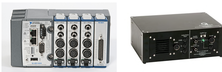
Rysunek 7.4: a) Sterownik Quanser Q1-cRIO [68], b) Wzmacniacz mocy VoltPAQ-X1 Amplifier [72]
